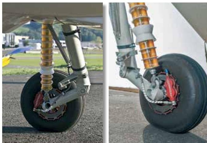
**Bello e funzionale il carrello ammortizzato con elementi elastomerici**
