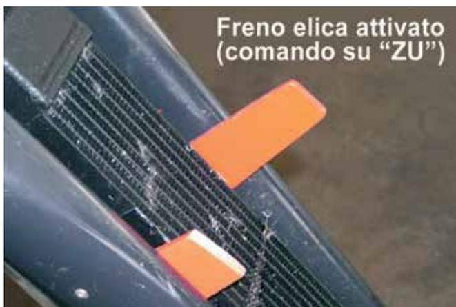
Freno dell'elica in posizione di "blocco", per la quale la leva deve stare su "ZU". Le palette rosse sono state estratte per eseguire la foto, dopo l'impatto. Una palette appare danneggiata, ma questo aspetto non è stato affrontato nella relazione BFU
