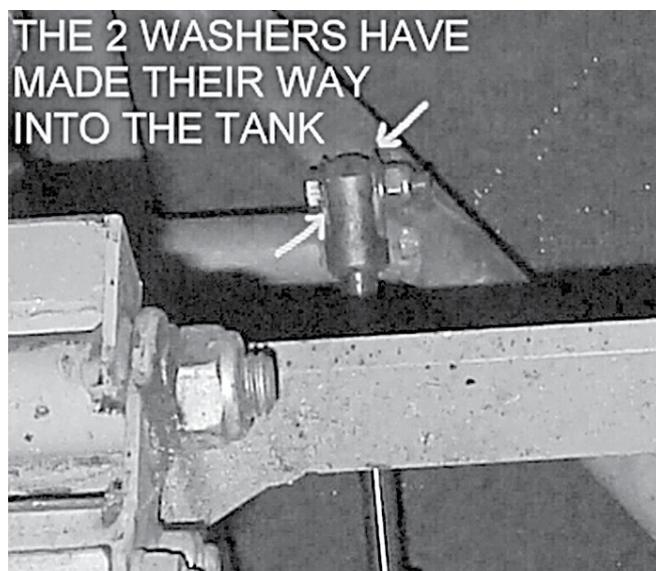
**Dettaglio delle rondelle che hanno danneggiato il serbatoio**
