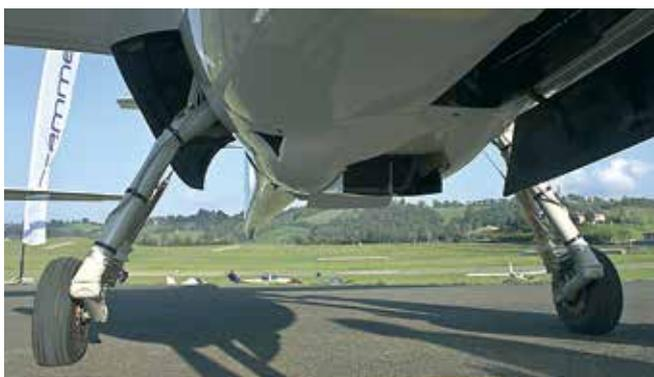
Il carrello principale ha traccia ampia, sufficiente per un'ottima stabilità al suolo
