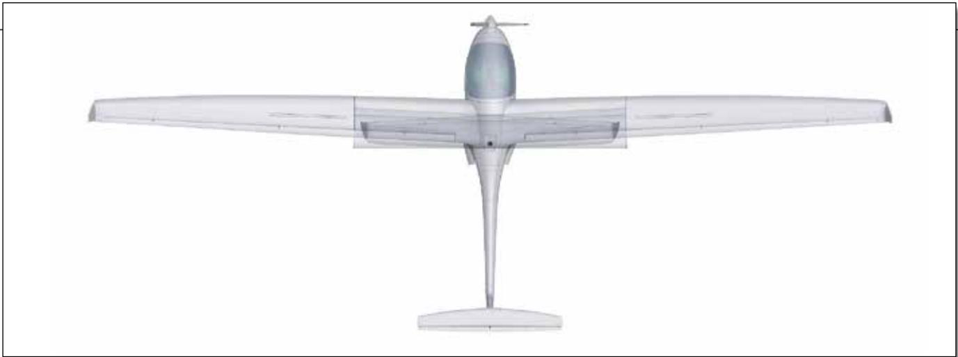
**Vista in pianta. In trasparenza è mostrato l'ingombro laterale quando le ali sono ripiegate per l'hangaraggio in spazi limitati**
