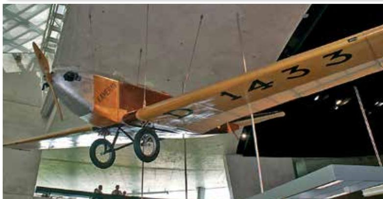
L'aereo Klemm L20 del 1928, un peso piuma con motore da 20 cavalli, potrebbe figurare come motoalante TMG
