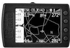
re (11 mm in più) che permette di alloggiare all'interno un logger FAI completo e una batteria che garantisce almeno 12 ore di autonomia alla massima luminosità. Il prezzo è ancora sconosciuto ma sappiamo che l'Oudie IGC sarà disponibile esclusivamente con software SeeYou originale, in quanto esso fa parte dello strumento anche ai fini dell'omologazione FAI come registratore di volo valido per tutti i livelli di performance.
