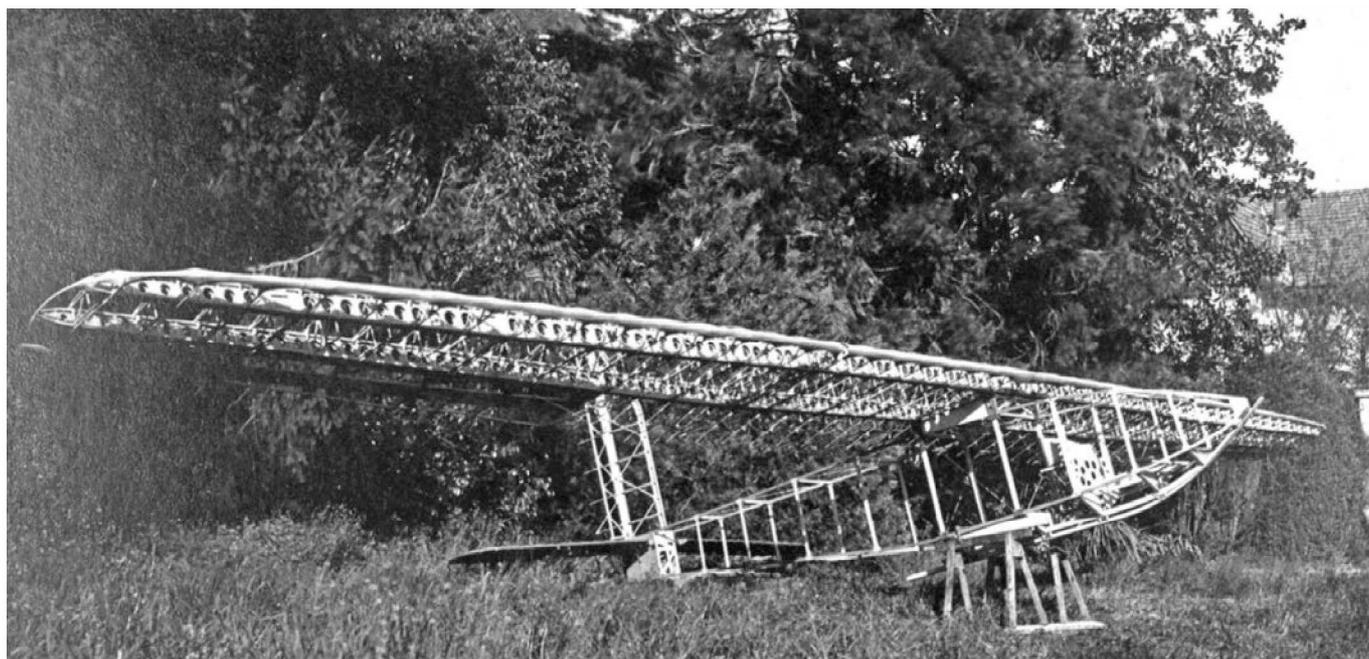
La complessa struttura a traliccio dell'ala. Semplice la costruzione della fusoliera
