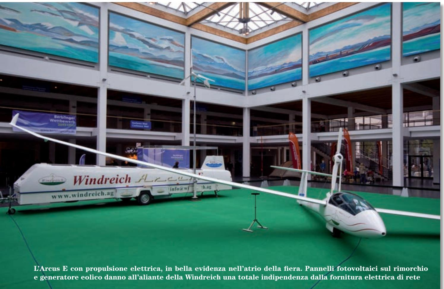
L'Arcus E con propulsione elettrica, in bella evidenza nell'atrio della fiera. Pannelli fotovoltaici sul rimorchio e generatore eolico danno all'aliante della Windreich una totale indipendenza dalla fornitura elettrica di rete
