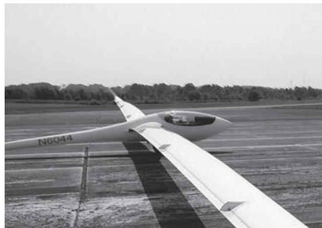
Con 28 metri d'apertura, profili modernissimi, un'accurata progettazione di ogni dettaglio inclusa l'intersezione tra ala e fusoliera, privo di motore e con un carico massimo pari a ben 62 kg/m<sup>2</sup>, il Concordia promette di essere un forte contendente per il prossimo titolo mondiale.
