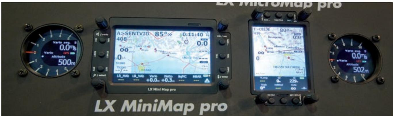
I sistemi LX Zeus e Minimap, della LXNavigation, con installata una versione modificata del software gratuito LK8000
