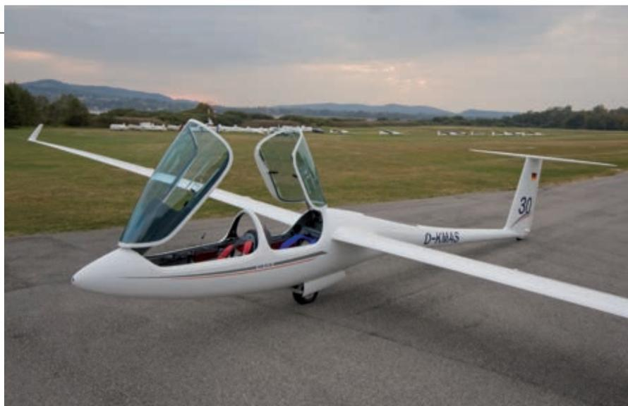
Una Rolls-Royce dell'aria, l'ASH-30 di 26,5 metri d'apertura, motorizzato Wankel
