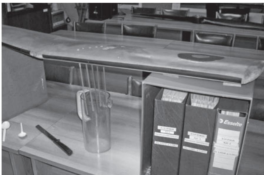
Il profilo alare, con le cannucce che dimostrano la depressione sull'estradosso, aspirando un liquido. L'ala è sostenuta dai faldoni dell'AIP Italia... Aerodinamica o burocrazia?
