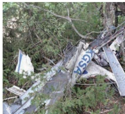
**Foto 6 - Posizione troncone di coda e zona centrale di fusoliera dopo l'impatto.**
