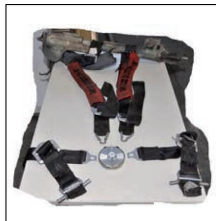
**Foto 7 - Blocco centrale di ancoraggio delle cinture di sicurezza**
