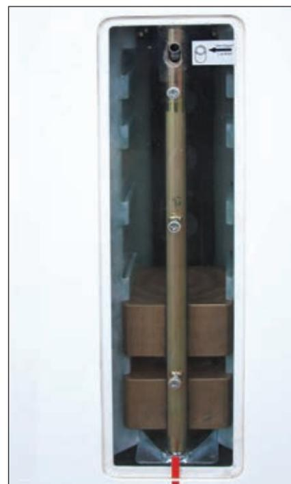
Il "trim-box" per inserire le zavorre metalliche. Una spia in abitacolo ricorda al pilota la verifica del centraggio
