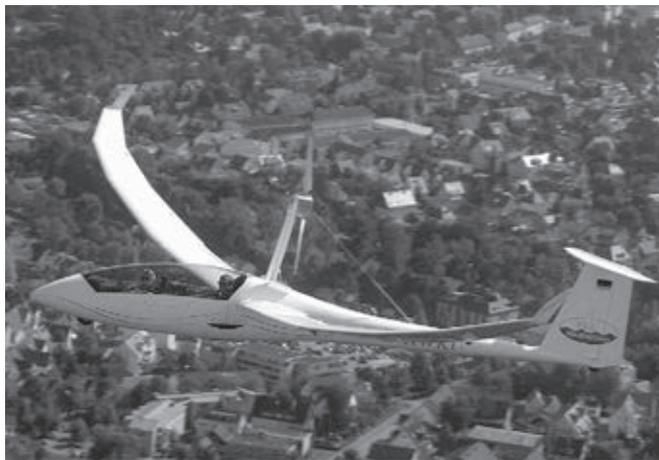
L'Arcus E sponsorizzato dalla Windreich è il primo esemplare dotato dello stesso motore elettrico già utilizzato sull'Antares. Le sue batterie al litio vengono ricaricate grazie a un generatore eolico installato sul tetto dell'hangar, facendo di questo il primo aliante che vola senza alcuna produzione, nemmeno indiretta, di CO2.
