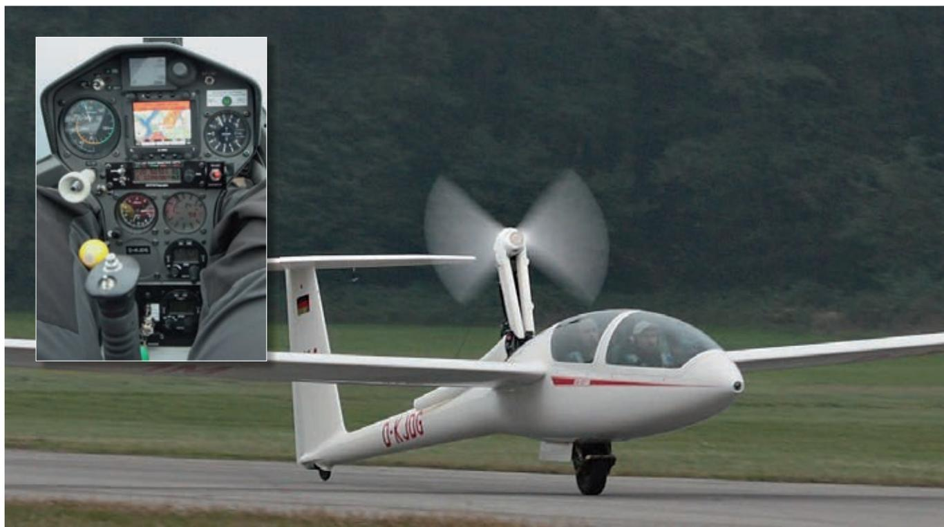
Il cruscotto ospita radio, xprd, computer di bordo, pannello DEI per il motore e il display Butterfly
