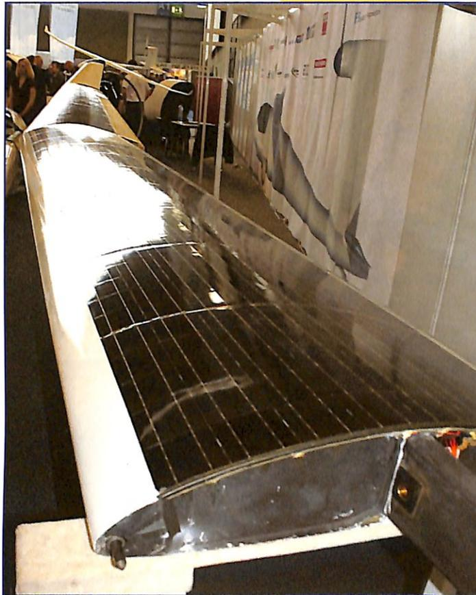
**Il glorioso aliante elettrico Icaré 2, che ha dimostrato dieci anni fa la realizzabilità del volo solare fotovoltaico. Fu presentato anche a Valbrembo**
