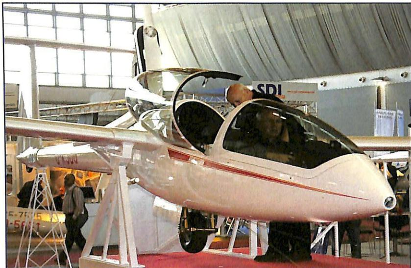
**Il DG-1000 nella nuova versione motorizzata a decollo autonomo, con 70 cavalli, iniezione elettronica con correzione della quota, e l'insolita trasmissione a catena**
