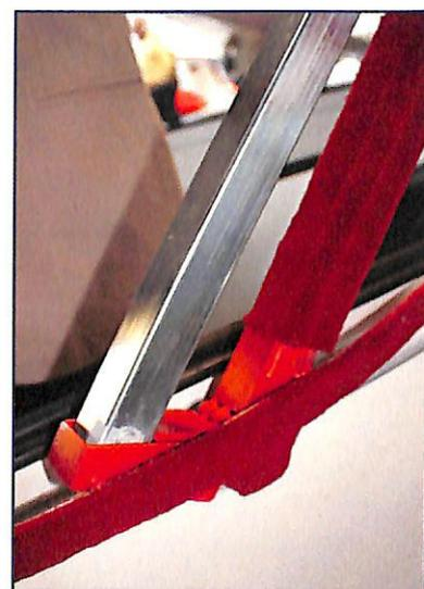
**Le innovazioni presentate sui rimorchi Cobra: alloggiamenti per le prolunghe da 21 metri dell'ASH-31, il nuovo fermo dei carrellini, la leva per sollevare la ruota di coda, e i montanti con molla a gas sdoppiata (utili per alianti con molti accessori appesi al tetto)**
