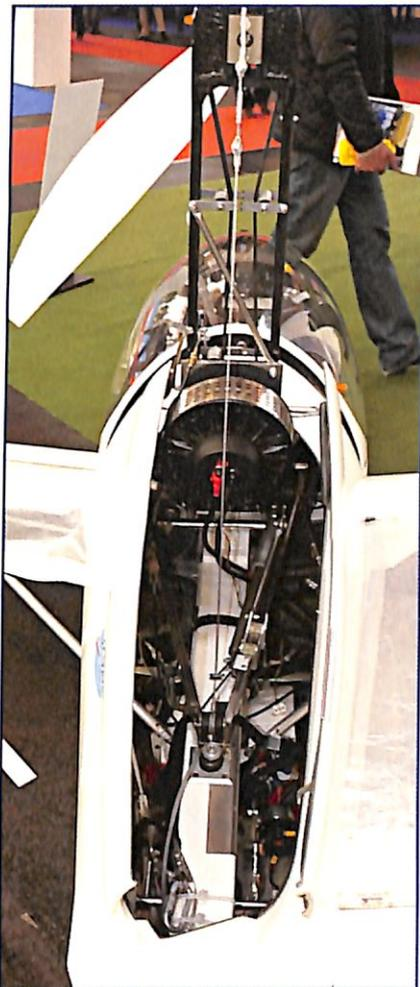
*L'Alatus AL-12 si caratterizza per le ali "arrotolabili" e il peso modesto, che ne permettono il trasporto sul tetto di un'auto. Le operazioni di smontaggio richiedono circa un'ora*
