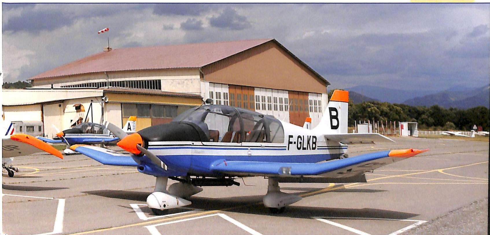
*Il treno d'atterraggio è molto robusto, come si conviene per il gravoso impegno di un aereo da traino*
