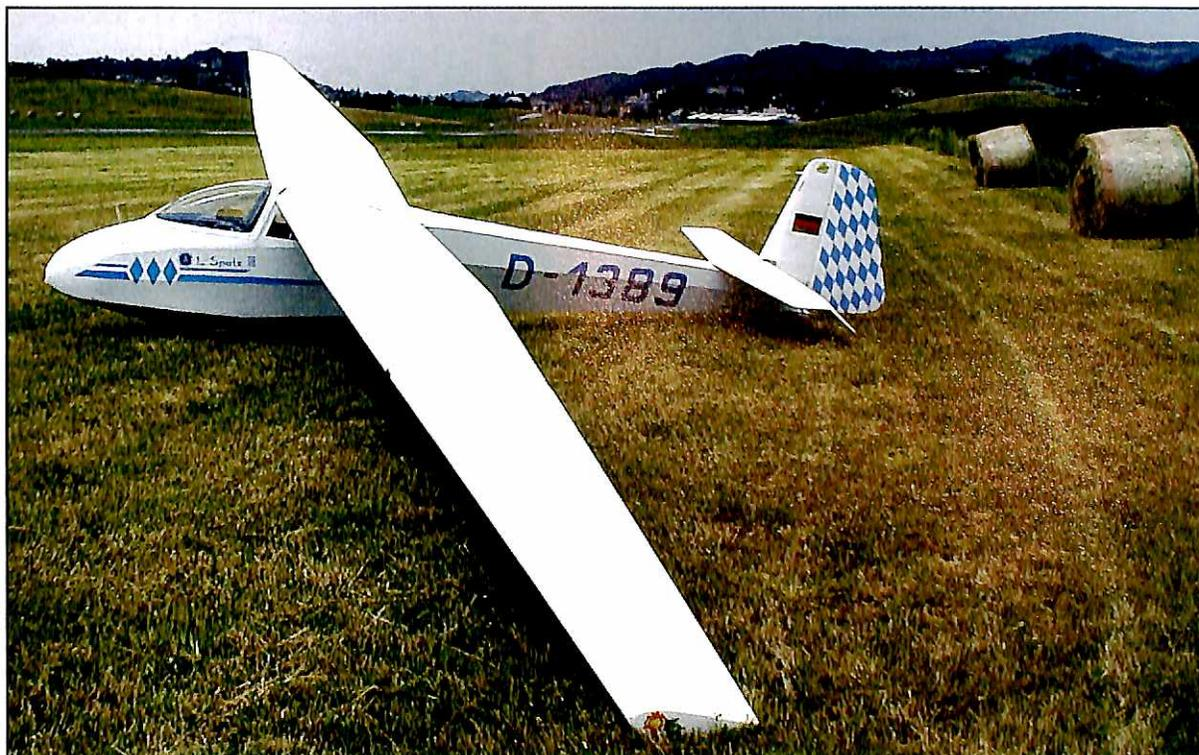
**Il monoposto L-Spatz III, con 15 metri d'apertura, è stato tra i primissimi alianti di classe Standard (1955)**
