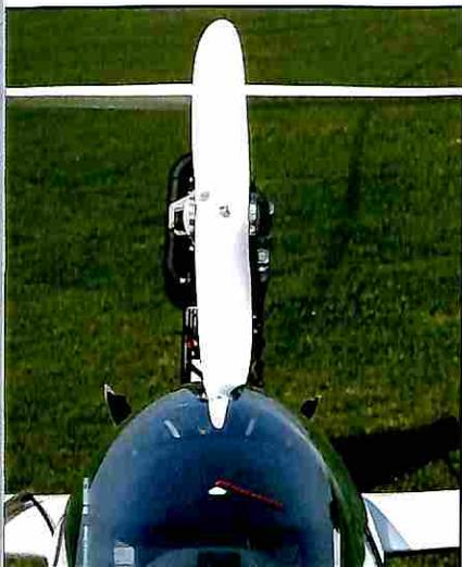
**Il controllo elettronico, allo spegnimento del motore, ne inizia una retrazione parziale; il piano dell'elica entra così nella zona d'azione del tampono in gomma fisso che garantisce la corretta posizione dell'elica per la retrazione completa**
