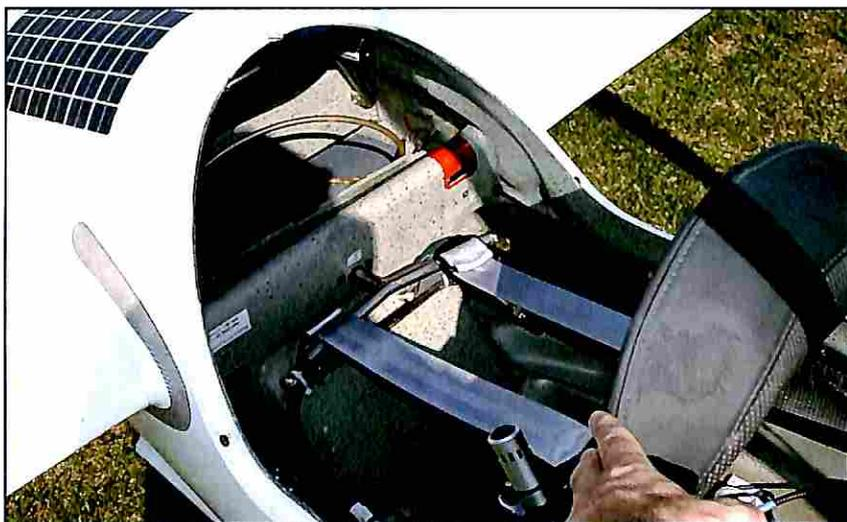
*Il sistema di regolazione e lo schienale possono venire rimossi per aumentare lo spazio a vantaggio dei piloti di statura molto elevata*
