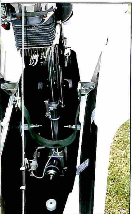
**I pilone del motore è comandato elettricamente. I coperchi del vano restano aperti quando il propulsore è estratto**
