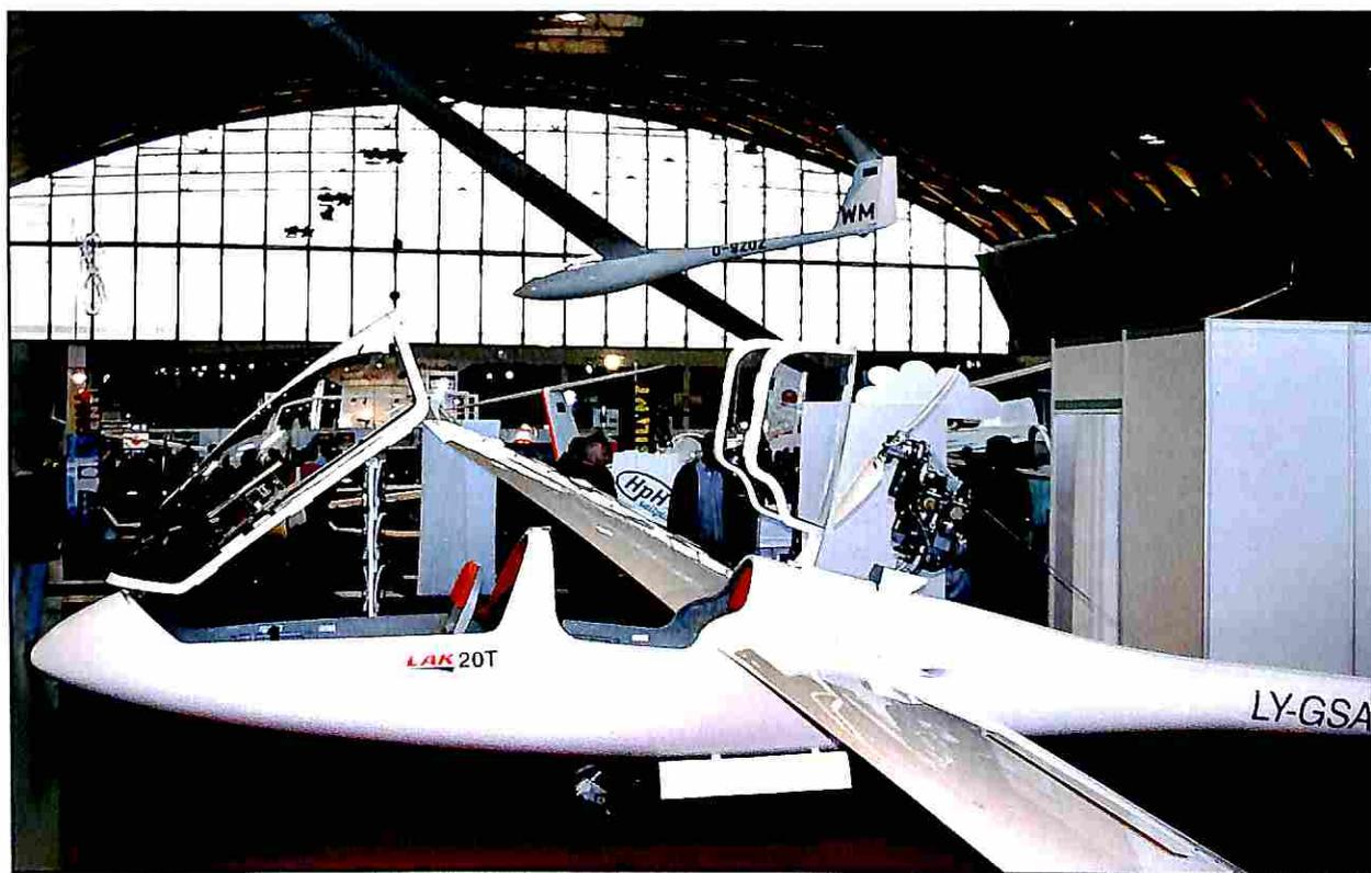
*LAK-20T con motore di sostentamento. La futura versione a decollo autonomo è la principale responsabile dell'inusuale carrello che scarica molto peso sulla coda*
