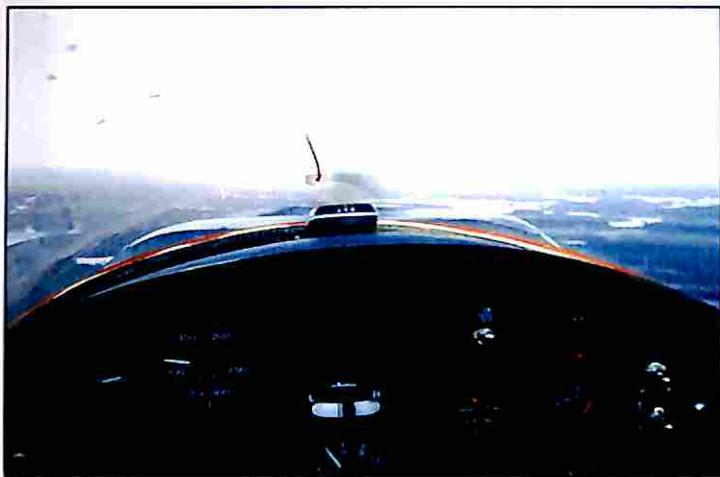
115 HP); la staccata è avvenuta in meno di 300 metri, e al termine della pista di 1.100 m il traino si trovava sempre ad una quota superiore ai 100 m. Nel volo senza aliante, il PIK-27 offre un rateo di salita di quasi 8 m/s. La visibilità esterna anteriore resta eccellente anche nell'assetto di salita.
