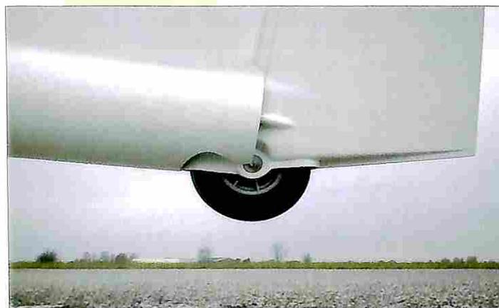
dove potrebbe atterrare senza problemi anche un 747. Mantenendosi con la ruota su un lato della pista, si riesce a rullare tenendo il ruotino dell'ala sull'asfalto. Il ruotino pivottante di coda, con il suo forte supporto, si inserisce gentilmente nella sezione posteriore della coda ed aiuta ad un preciso rullaggio.
