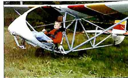
senza profilo, con struttura in tubi metallici e copertura in tela. Il carrello d'atterraggio è ben ammortizzato. In Polonia è stato prodotto un altro aliante primario
