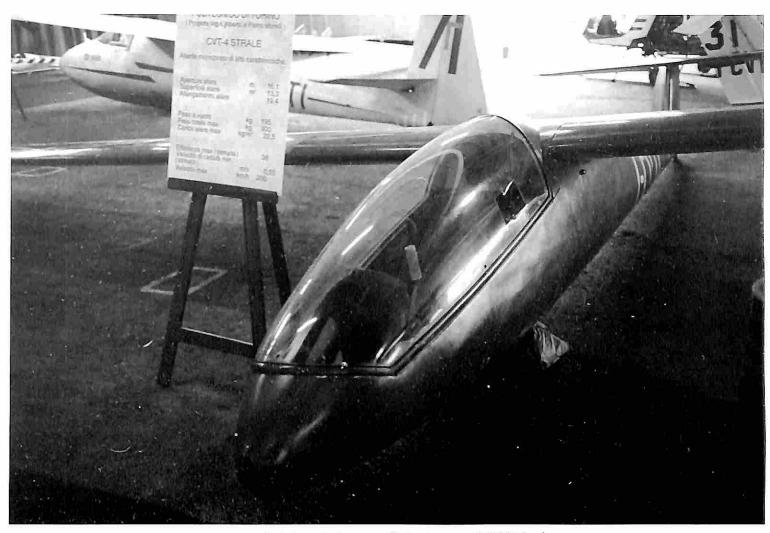
Posizione sdraiata e profilo laminare per il CVT4 Strale
