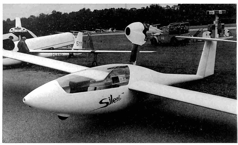
Il Silent in versione self-launching con motore fisso
