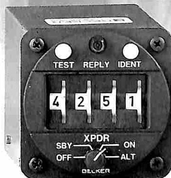
mando dell'ATC 2000 R -(2) permette innanzitutto il montaggio in coppia assieme al COM AR 3201 oppure al ricevitore NAV 3301. Però anche come apparecchiatura montata singolarmente è inseribile in un foro standard da 58 mm di diametro. Può essere usato sia a 14 V, che a 28 V per merito dell'adattatore automatico di tensione.
