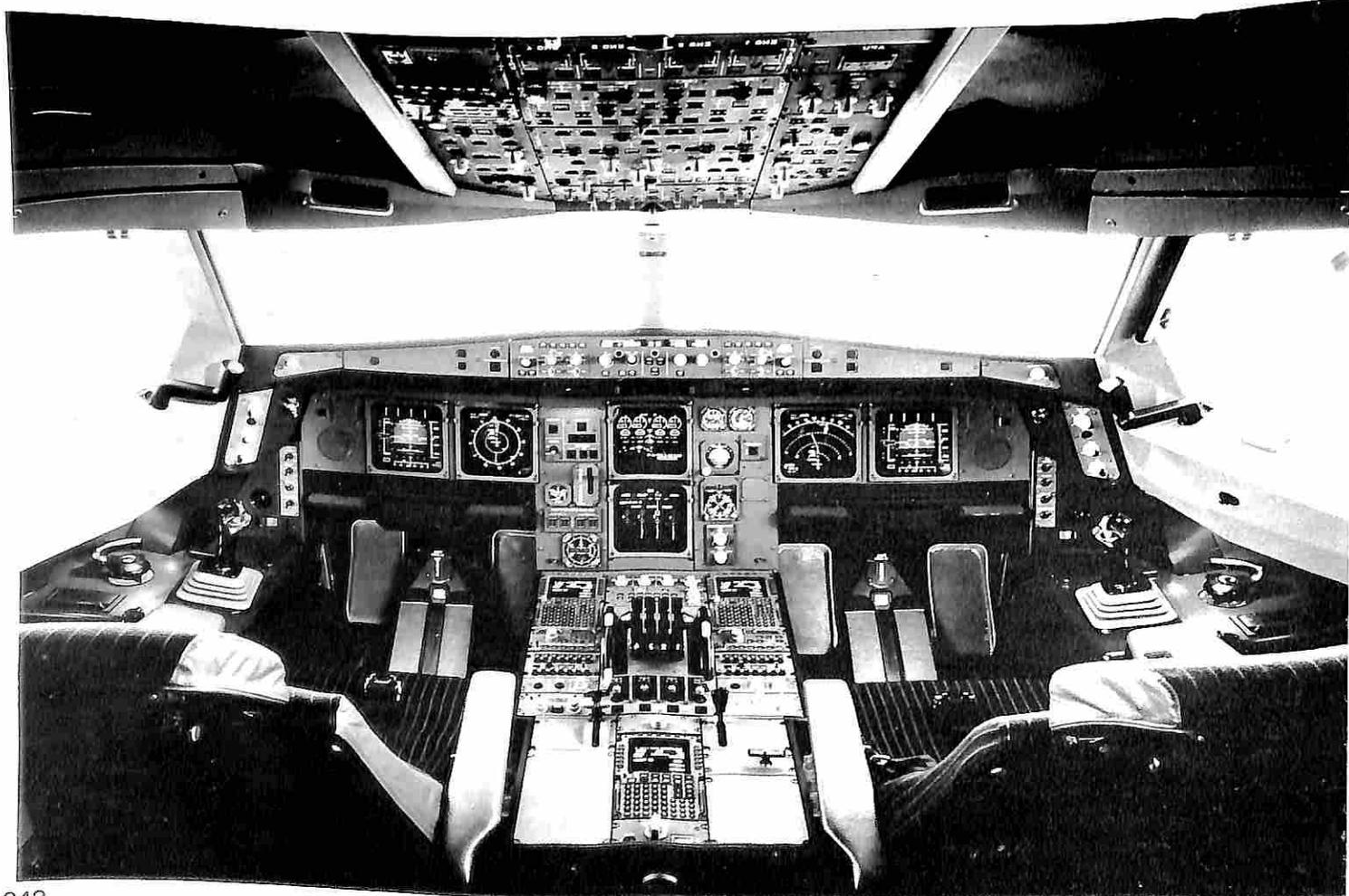
peo avviene tramite comandi denominati "fly-by-wire" che hanno sostituito (con più affidabili cavi a fibre ottiche) gli ormai superati impianti idraulici e pneumatici. La condotta del velivolo avviene materialmente tramite un comando laterale detto "joystick" che sostituisce la tradizionale 'barra' di comando. La strumentazione si concentra in sei grandi schermi a tubi catodici che consentono il controllo di tutti i parametri di volo, compresi quelli relativi ai motori.
