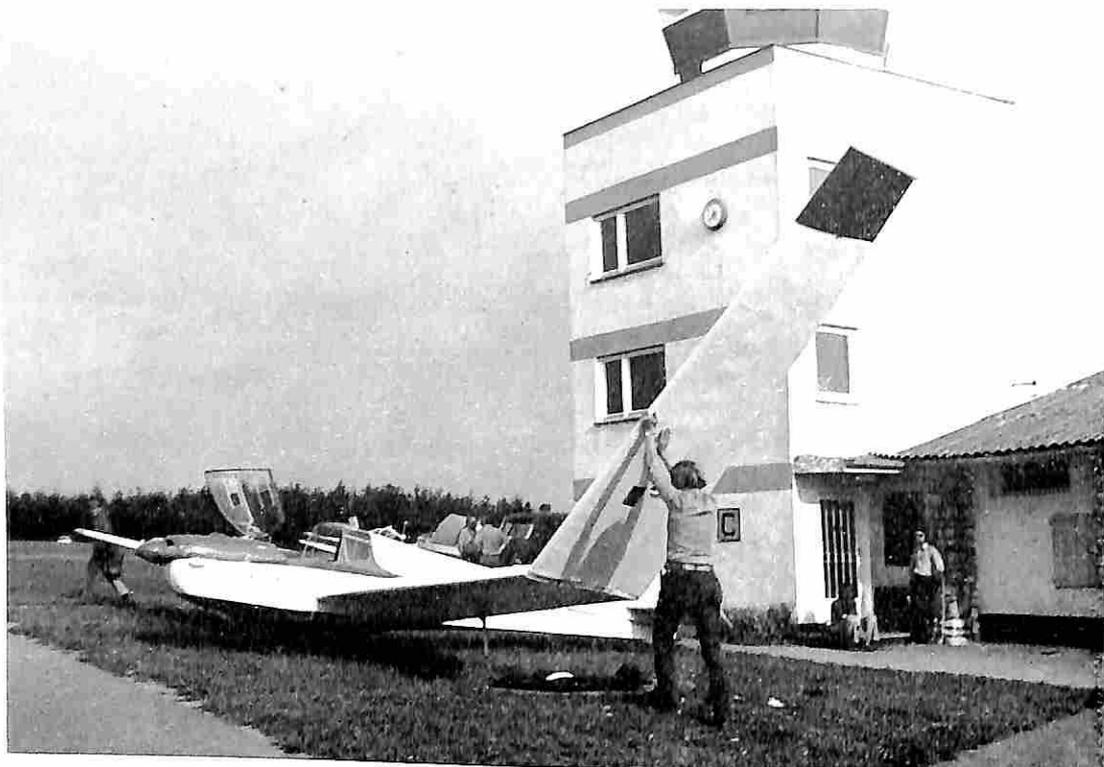
La sezione alare è rimasta la stessa ma gli elementi esterni, ciascuno di 5 metri, possono essere ripiegati all'interno. Ne risulta un ingombro di circa 10 metri il che facilita la sistemazione negli hangars.
