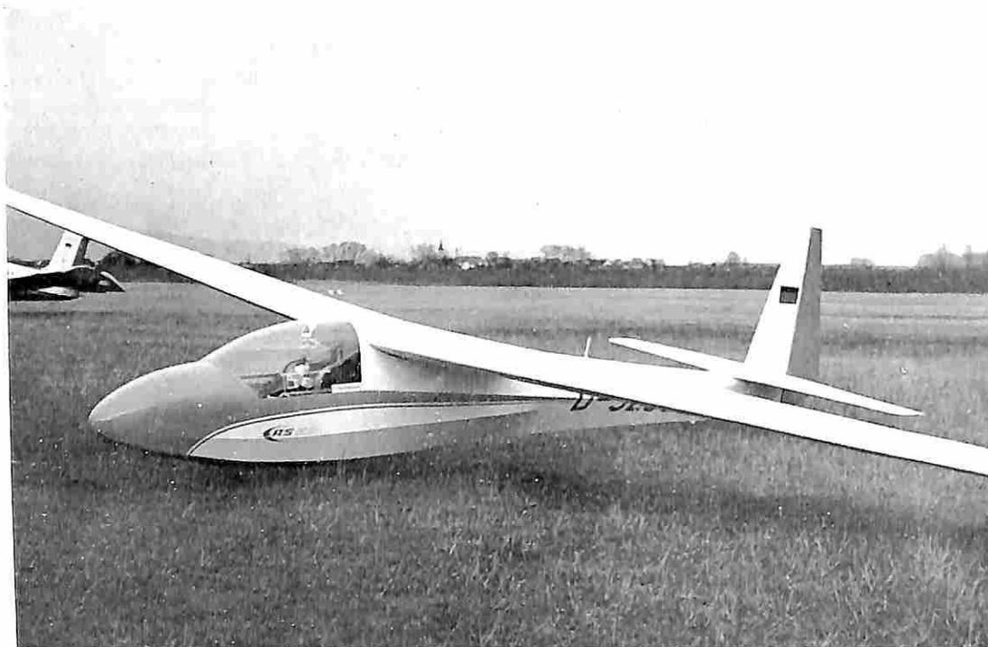
Struttura in tubolare d'acciaio con listelli profilati e rivestimento in tessuto. La prua è rivestita con un guscio in vetroresina. Gancio Kombi baricentrale, carrello fisso a monoruota 5.00-5 con freno a ganasce interne, pattino di coda in espanso.
