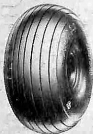
L'atterraggio è uno dei momenti del volo in cui l'aereo è sottoposto a uno sforzo particolare. Al centro di questo sforzo sono i pneumatici che debbono sopportare l'urto sul terreno del velivolo lanciato ad alta velocità.
