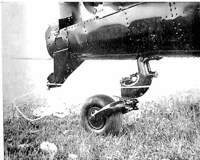
Il gancio per il traino di alianti non è montato arichiesta ma fa parte della struttura di ogni macchina.
