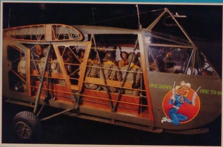
Questo velivolo era dotato di un sistema di comunicazione di tipo telefonico che correva lungo il cavo di traino, il quale permetteva un collegamento permanente con il rimorchiatore (generalmente il bimotore C-47). I soldati aviotrasportati si accomodavano su semplici panche in compensato, poste ai lati di fusoliera; questa era illuminata da tre piccoli oblò situati su ciascun lato. Sulle fiancate erano presenti anche quattro portelloni che agevolavano l'uscita degli uomini appena atterrati.
