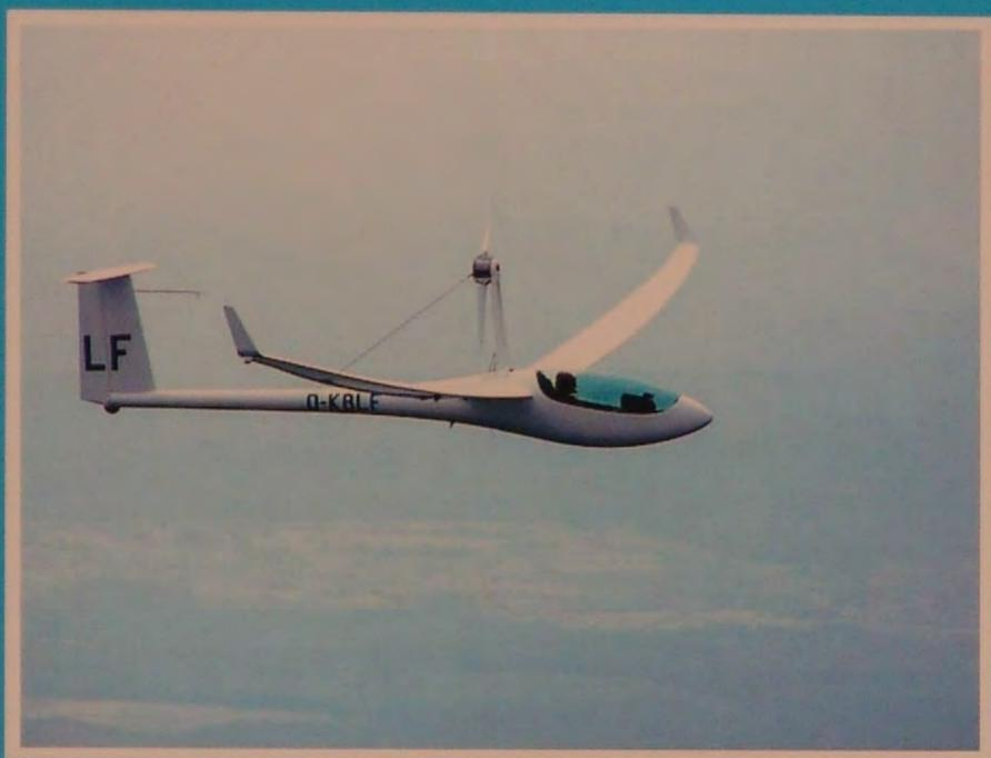
Nel primo caso i motori sono definiti "self launching"; nel secondo, "self sustaining". Molto interessanti e varie sono le soluzioni adottate dai costruttori, nei diversi modelli, per l'alloggiamento del complesso motore ed elica all'interno della stretta fusoliera, quando l'aliante è in veleggiamento, così come ai complessi cinematismi utilizzati per suo il dispiegamento/ripiegamento.
