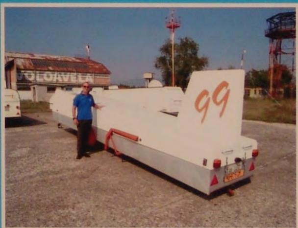
1. La fusoliera dell'aliante, fissata ad una apposita sella che la mantiene verticale, viene sfilata dal carrello.
