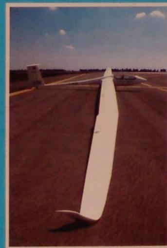
Con lo sviluppo nelle costruzioni compare presto una seconda generazione di alianti, la classe **Libera** (*Nimbus 2*, *ASW 17*, *Glasflügel 604*), dotati di flaps e con aperture alari da 17 a 20 metri (massimo praticamente consentito dalla vetroresina).
