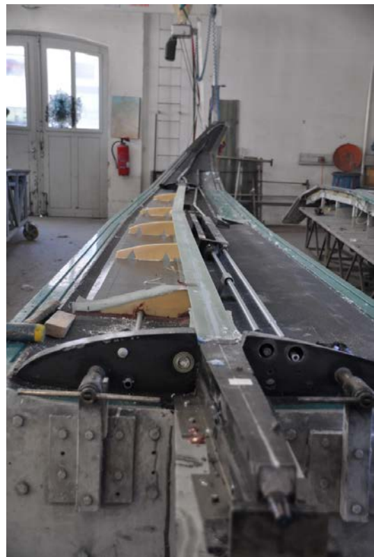
L'ala di un Arcus in fase di allestimento sullo scalo di produzione nel reparto ali
