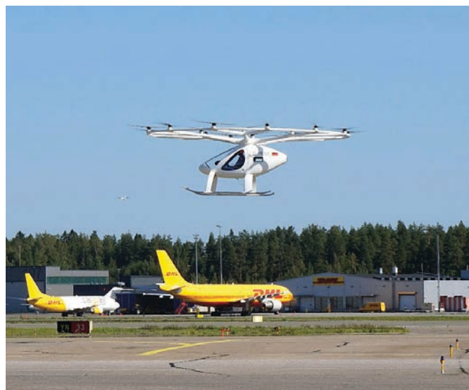
Il Volocopter è un multirottore con motori elettrici
