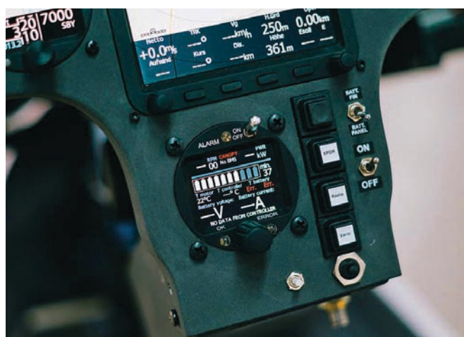
Unità di controllo del motore e batterie, da tenere ON durante il volo
