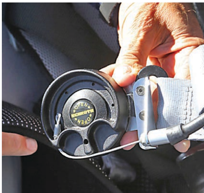
Cavo per sgancio automatico delle cinture (sistema NOAH)
