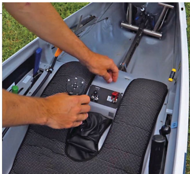
I comandi elettrici dei nettamoscerini e il master del motore
