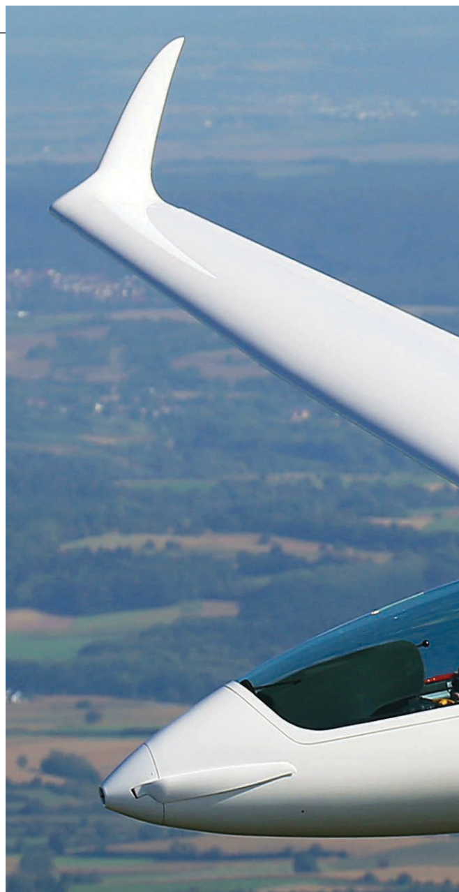
In volo planato con elica ripiegata. La winglet è ben disegnata
