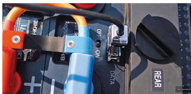
I BMS sono integrati nel pacco batteria. Per la carica va sbarcata
