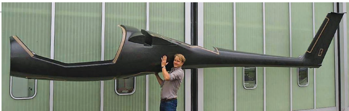
Una dimostrazione del notevole risparmio di peso grazie ai prepreg e alla tecnica di costruzione
