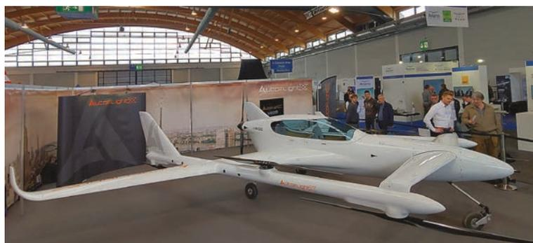
**Curiosità: AutoFlightX, decollo verticale con 6 motori elettrici, crociera con un motore spingente**
