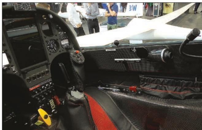
Sulla destra il comando di emergenza del carrello (anch'esso elettrico con una batteria separata)
