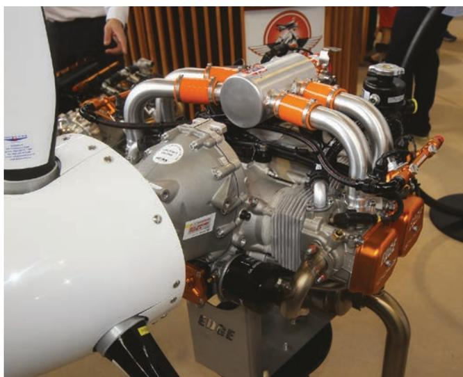
Il motore Edge, un Rotax elaborato per ben 155 HP e TBO di ben 2.000 ore
