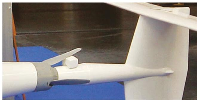
Dettaglio dell'elica montata a manicotto sulla fusoliera (il cubo serve solo a evidenziare l'elica)
