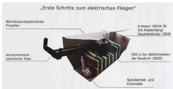
**Lo schema del propulsore. 600 celle litio “18650” integrate in fusoliera**
