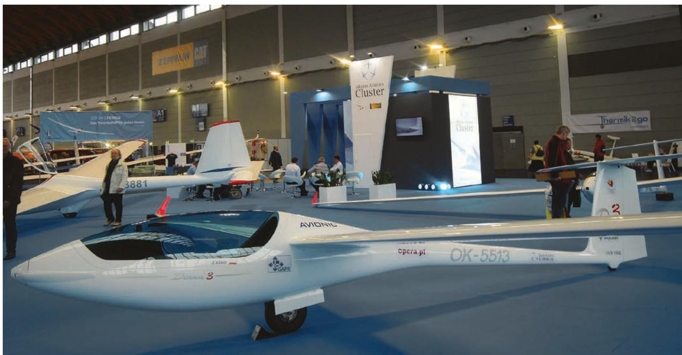
Il Diana 3: un prototipo dotato di ala nuova da 18 metri (che sarà ulteriormente migliorata), innestata su una fusoliera del KKB18. Sono previste versioni allungate per la Classe Libera
