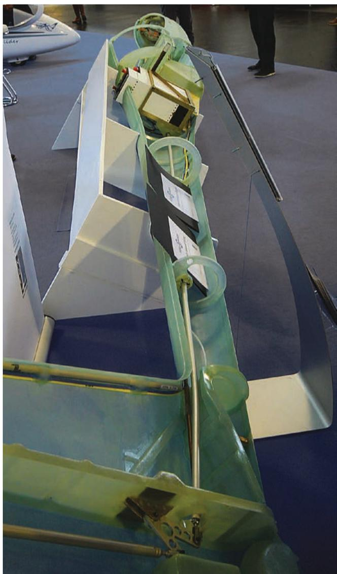
La struttura della fusoliera SZD-55, modificata per installare un'imitazione del FES. Retrofit a 12.00 euro
