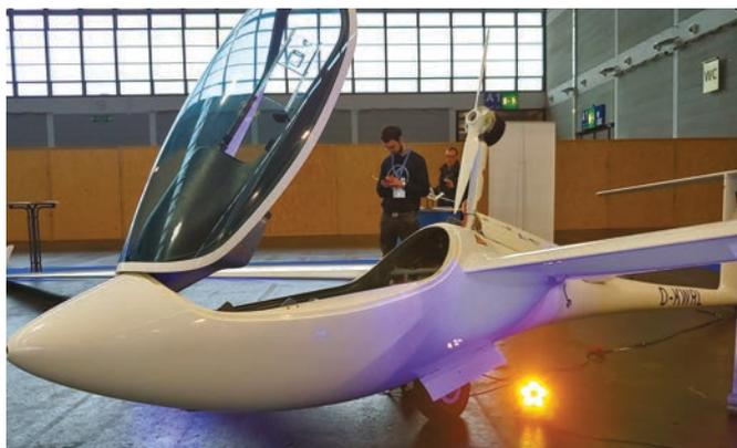
**FVA-29, prototipo con motore elettrico basato su ASG29**
