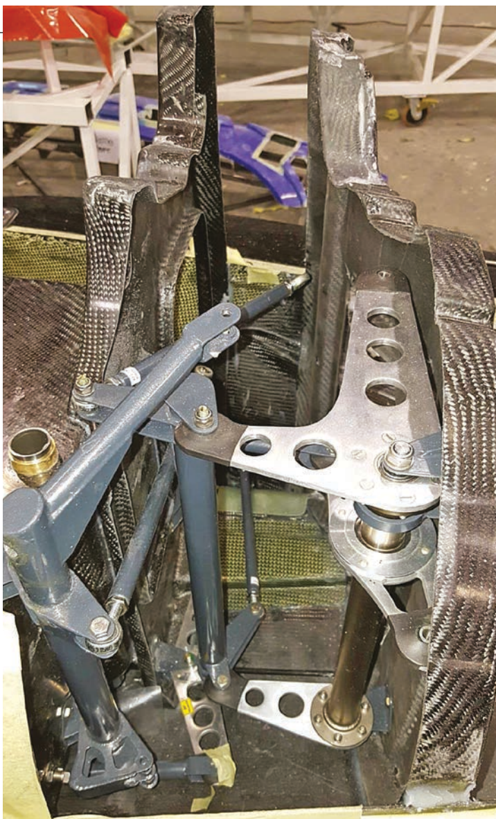
La realizzazione dei rinvii e del mixer dei comandi in fusoliera
