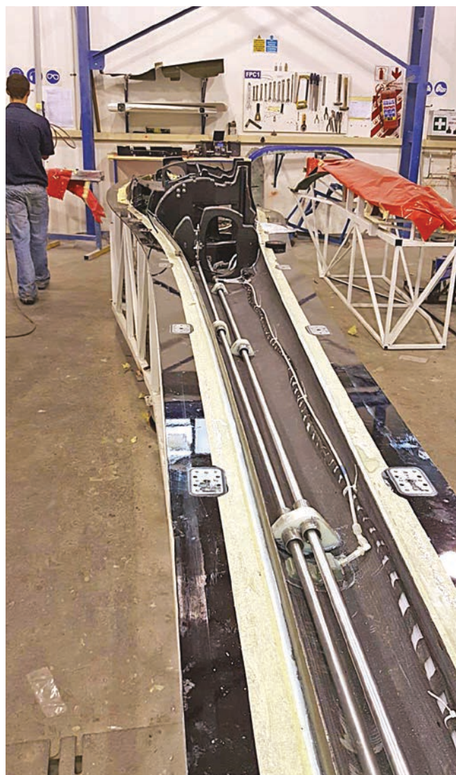
Le due aste dei comandi: una per l'elevatore, l'altra per il timone direzionale
