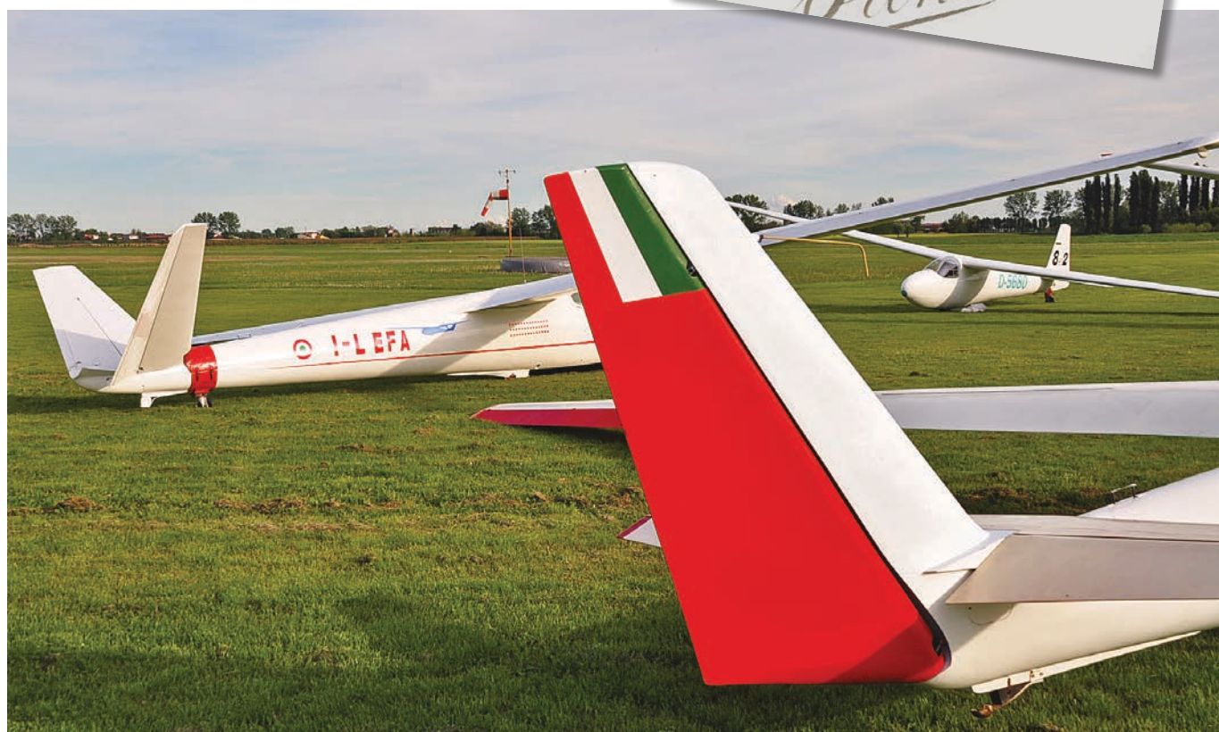
In alto, l'ing. Ciani nell'abitacolo dell'Urendo B. Qui sopra, il confronto tra le code dell'Uribel C I-LEFA e della versione D (in primo piano)
