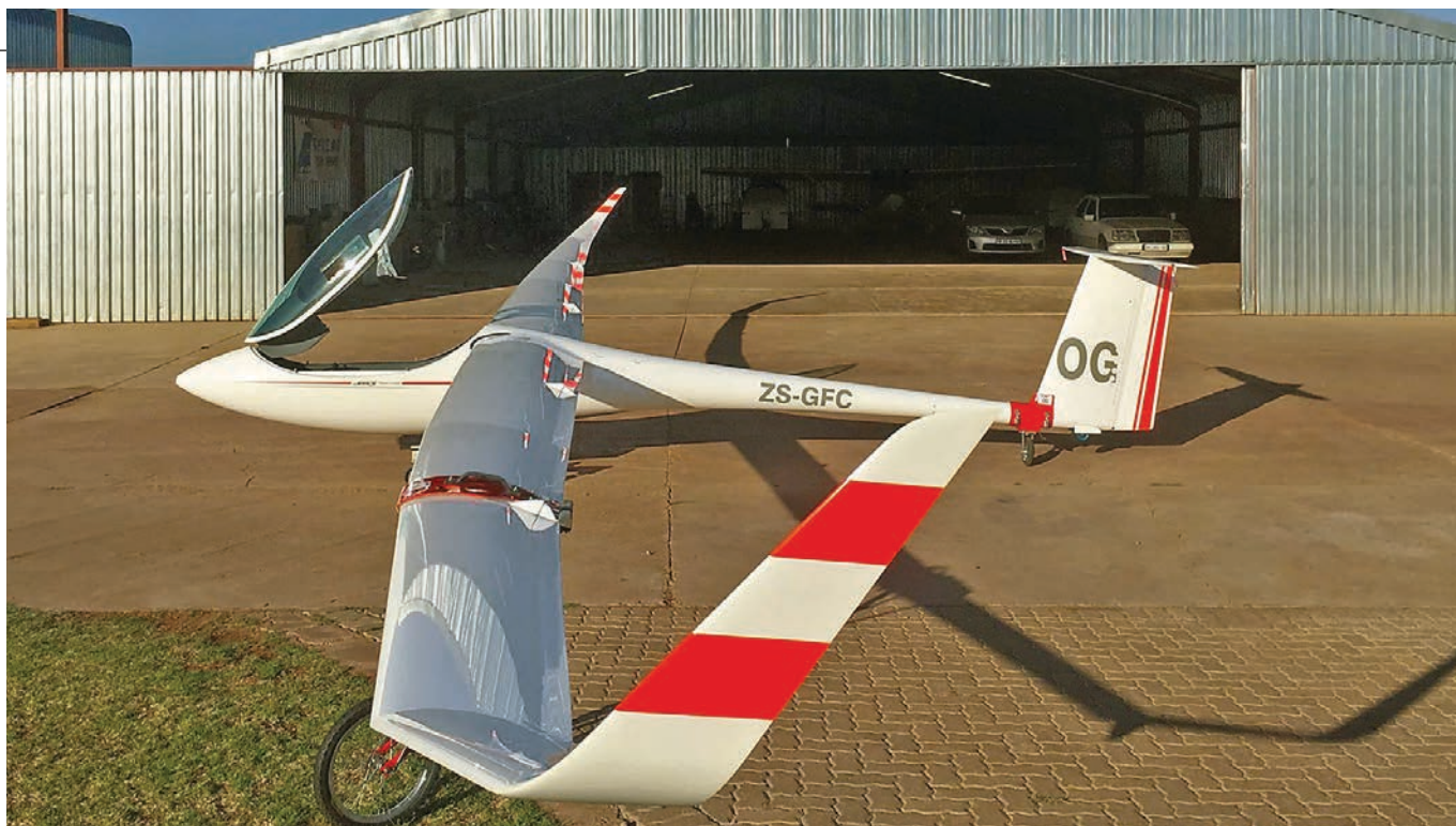
Un altro dei primi esemplari del JS 3. Il ruotino di coda è retrattile. La capottina ha un taglio differente dal JS 1, con meno superficie trasparente
