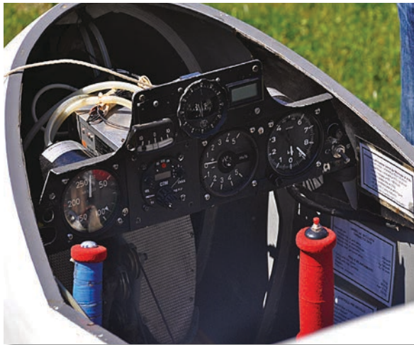
Abitacolo e cruscotto Uribel C, con strumenti pneumatici
