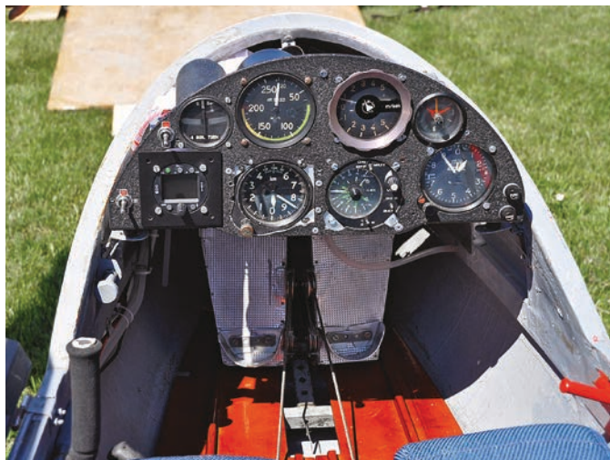
Uribel D con radio moderna e vario elettrico Ilec
