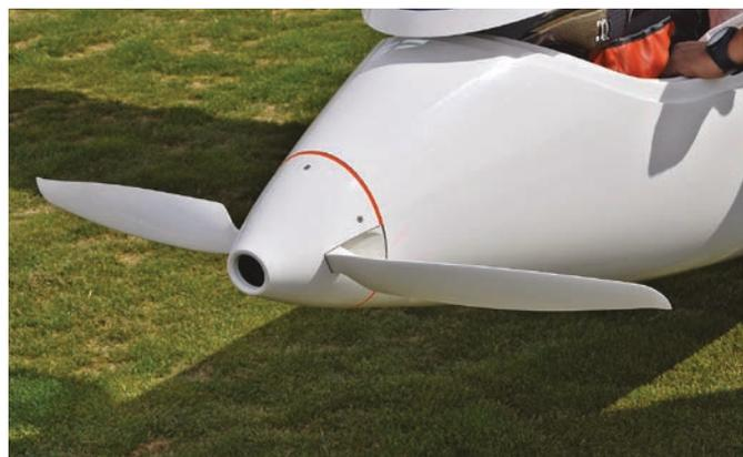
L'ultimo arrivato nella gamma 304 è la versione con motore elettrico FES per il sostentamento
