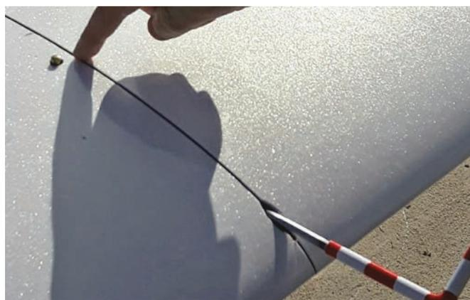
**La vite di estrazione inserita nel passaggio anteriore. Peccato per la spina di sicurezza, ben visibile ma sporgente sul profilo alare**
