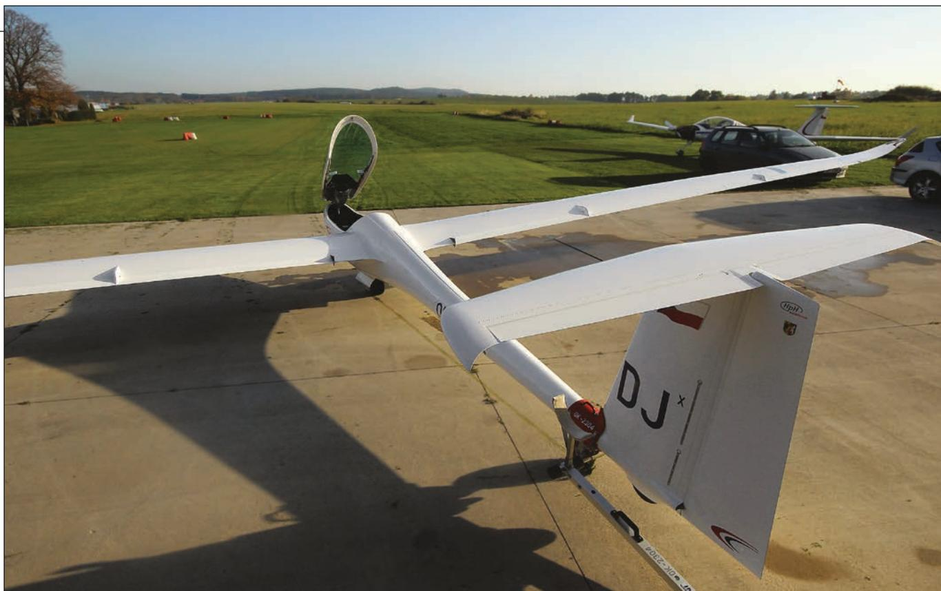
La finitura in pellicola non è molto promettente. Equilibrata la linea dell'aliante. I terminali del piano orizzontale sono piegati verso il basso, simulando delle winglet
