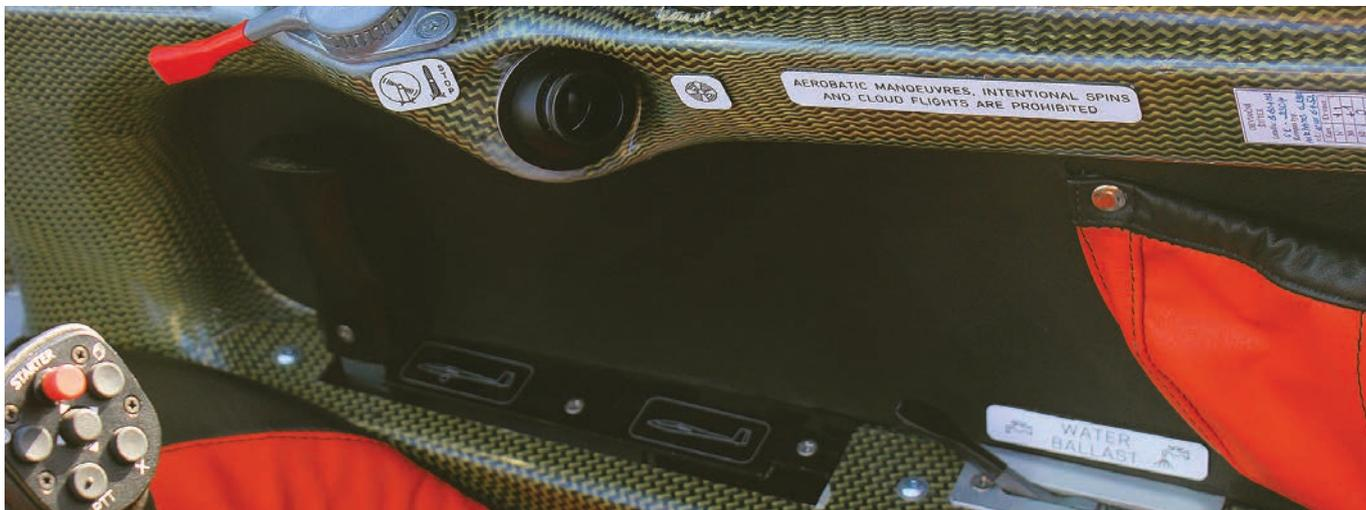
Sulla barra i comandi del microfono, del computer di bordo e (rosso) il pulsante di avviamento. A destra la leva (rosso) del fermo-elica, la bocchetta di ventilazione, e (nero) la grossa leva del carrello retrattile
