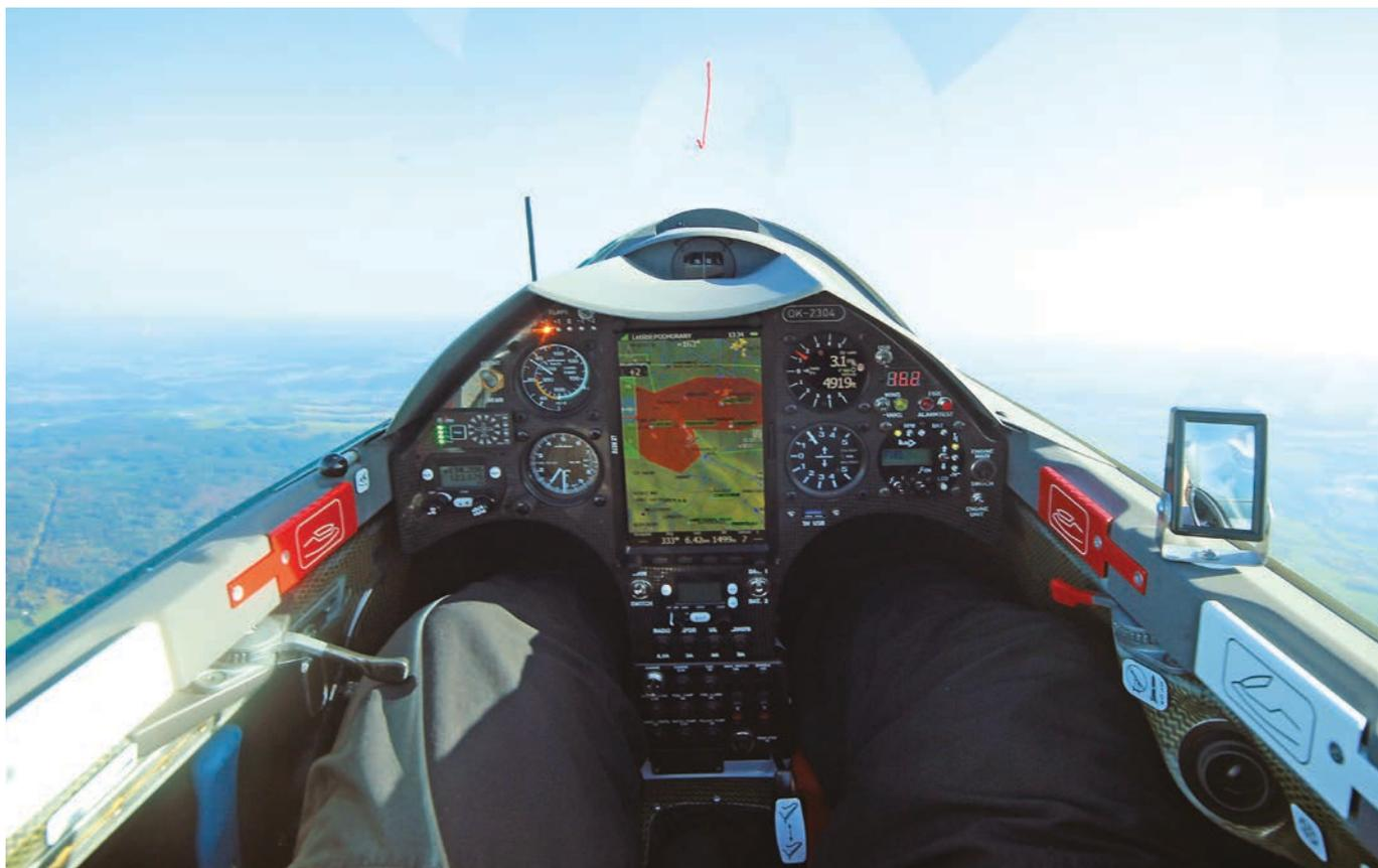
**In salita a motore, con circa 3 m/s. L'estrazione del motore è rapida (batterie al Li-MN da 16 v) e l'avviamento immediato. Il motore gira regolare, senza incertezze di carburazione**
