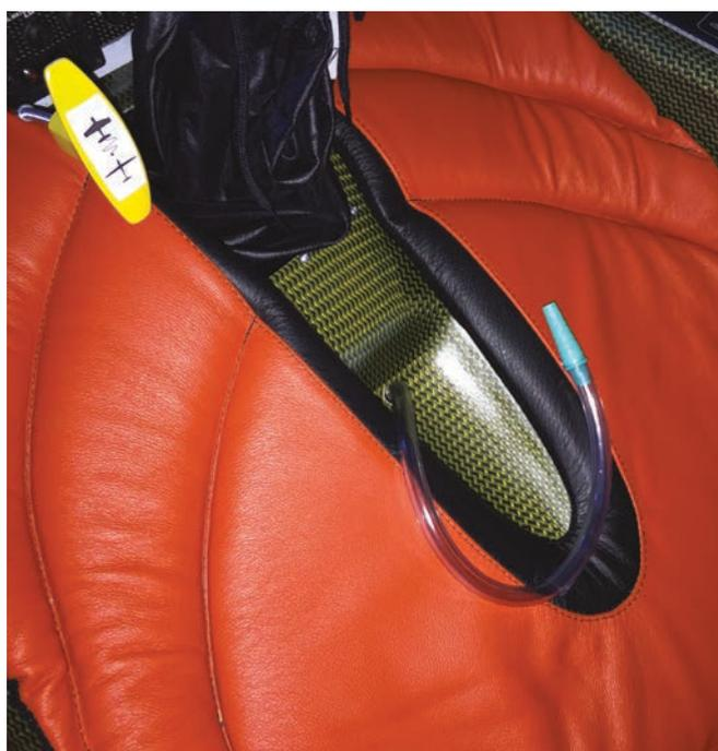
Il tubo per allacciare un sistema di "scarico" ad uso del pilota
