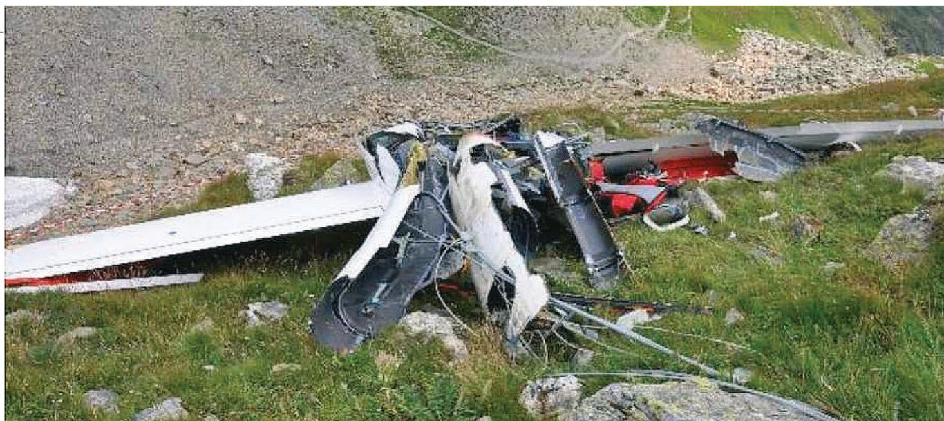
Foto 4: la distruzione dell'abitacolo e della fusoliera. Danni più limitati alle semiali
