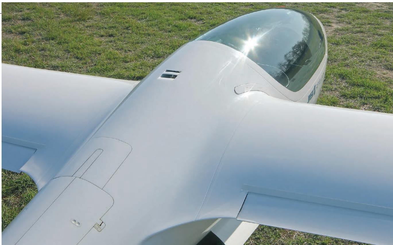
**Zona ala/fusoliera: lo spessore dell'ala cresce e ha un profilo adatto; nettamoscerini integrati; apertura di scarico dell'aria dall'abitacolo; i complessi coperchi del motore jet**
