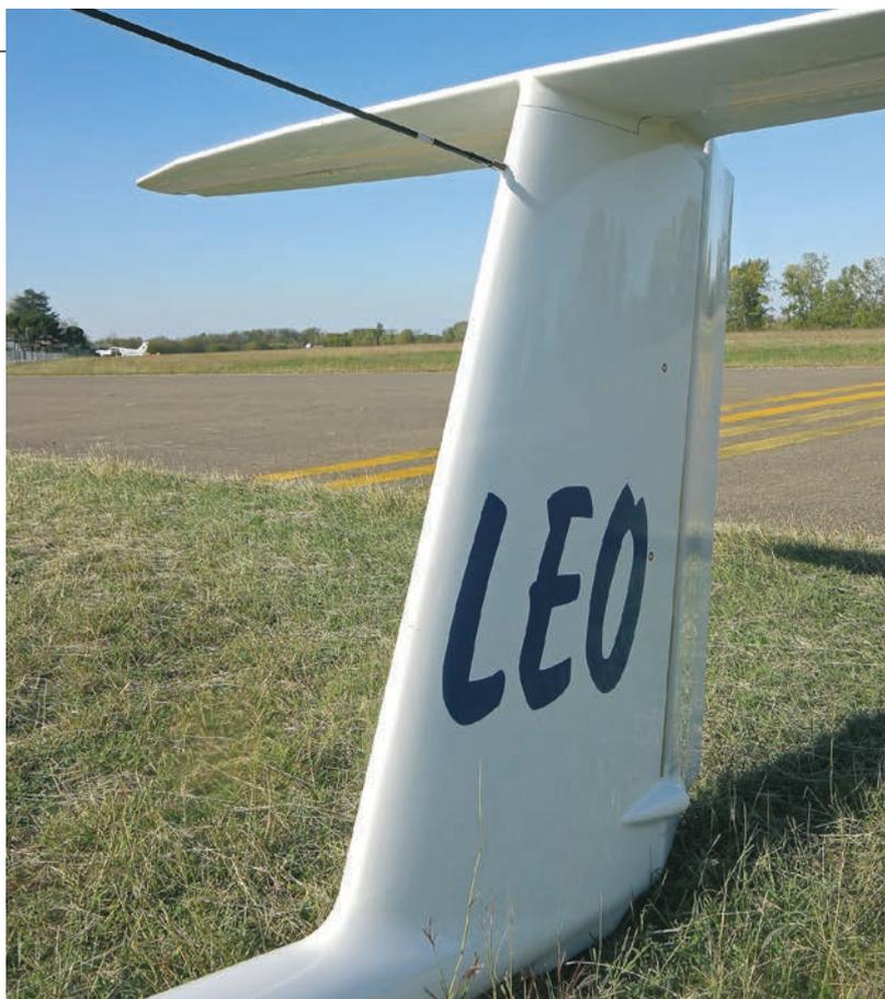
**La deriva incorpora due serbatoi d'acqua: uno per il centraggio fine (non scaricabile), l'altro per compensare la zavorra nelle ali**
