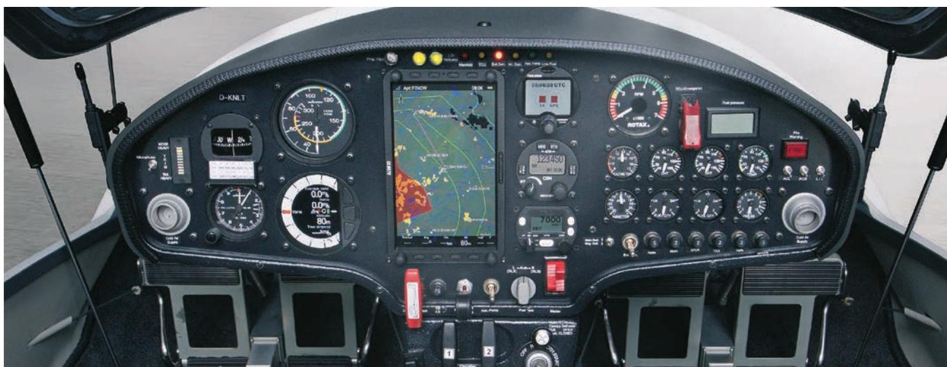
**Il pannello nell'edizione “Soaring”, con ottimo variometro elettronico di moderna concezione. Il pilota automatico non è previsto (con sollievo per la leggerezza dei comandi)**
