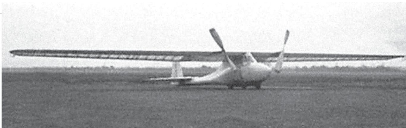
**Il Pedaliante di Bossi e Bonomi, progettato da Silva. Struttura esageratamente robusta e l'inutile complicazione delle due eliche. Ma, a conti fatti, poteva sostenersi in volo dopo un lancio dinamico**
