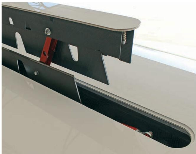
Magnifica lavorazione della piastra di chiusura e del box diruttori. Lame in composito
