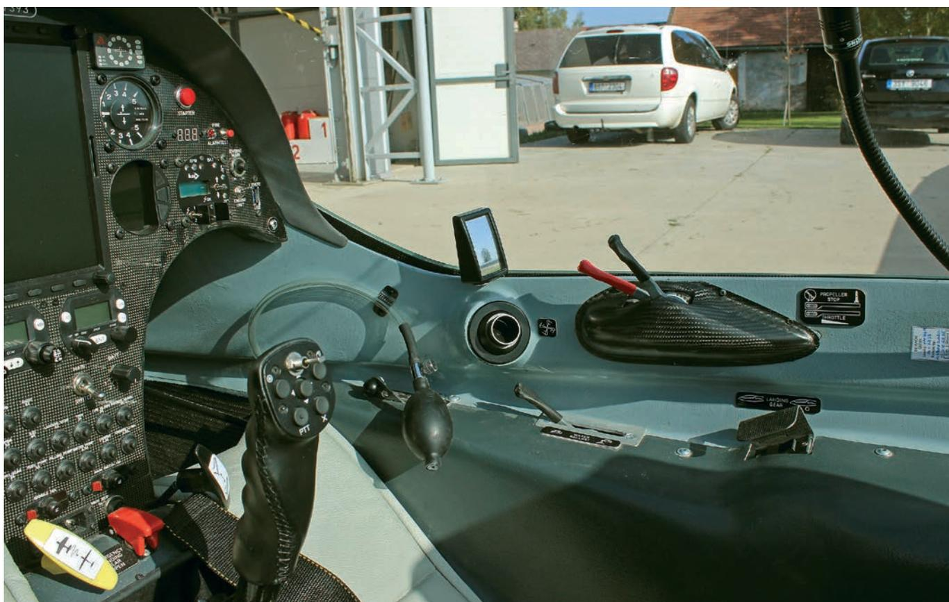
Sul pannello c'è un voltmetro digitale per le batterie del motore (si ricaricano al banco, dopo il volo). La pompetta pneumatica della benzina per l'avviamento. I comandi del gas e del freno elica sono interconnessi per sicurezza. Scarico acqua separato per la coda
