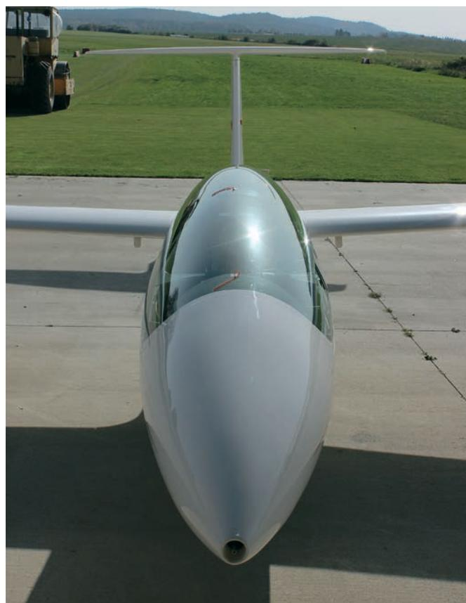
**Il profilo alare è sottile anche in prossimità della fusoliera**
