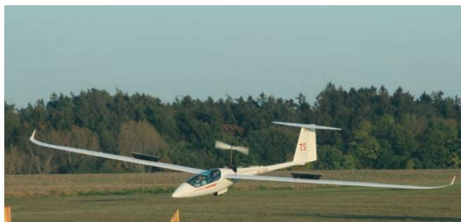
**Col freno tirato e un po' di potenza, si alza la coda per ruotare sul posto. Non c'è il ruotino sterzante**
