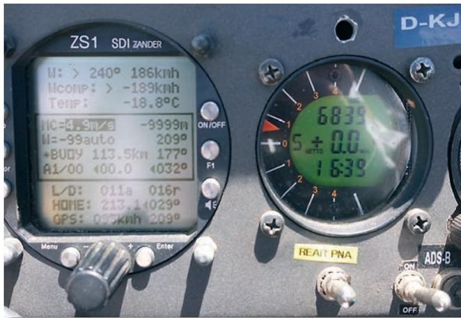
Il computer Zander calcola 189 km/h di vento e siamo a 213 km da casa. L'applicazione del valore di “equivalente McCready” richiede di impostarlo a fondo scala (4,9 m/s) per ottenere la migliore planata possibile, che in questo caso è meno di 10! Ma il calcolo è esatto e funziona
