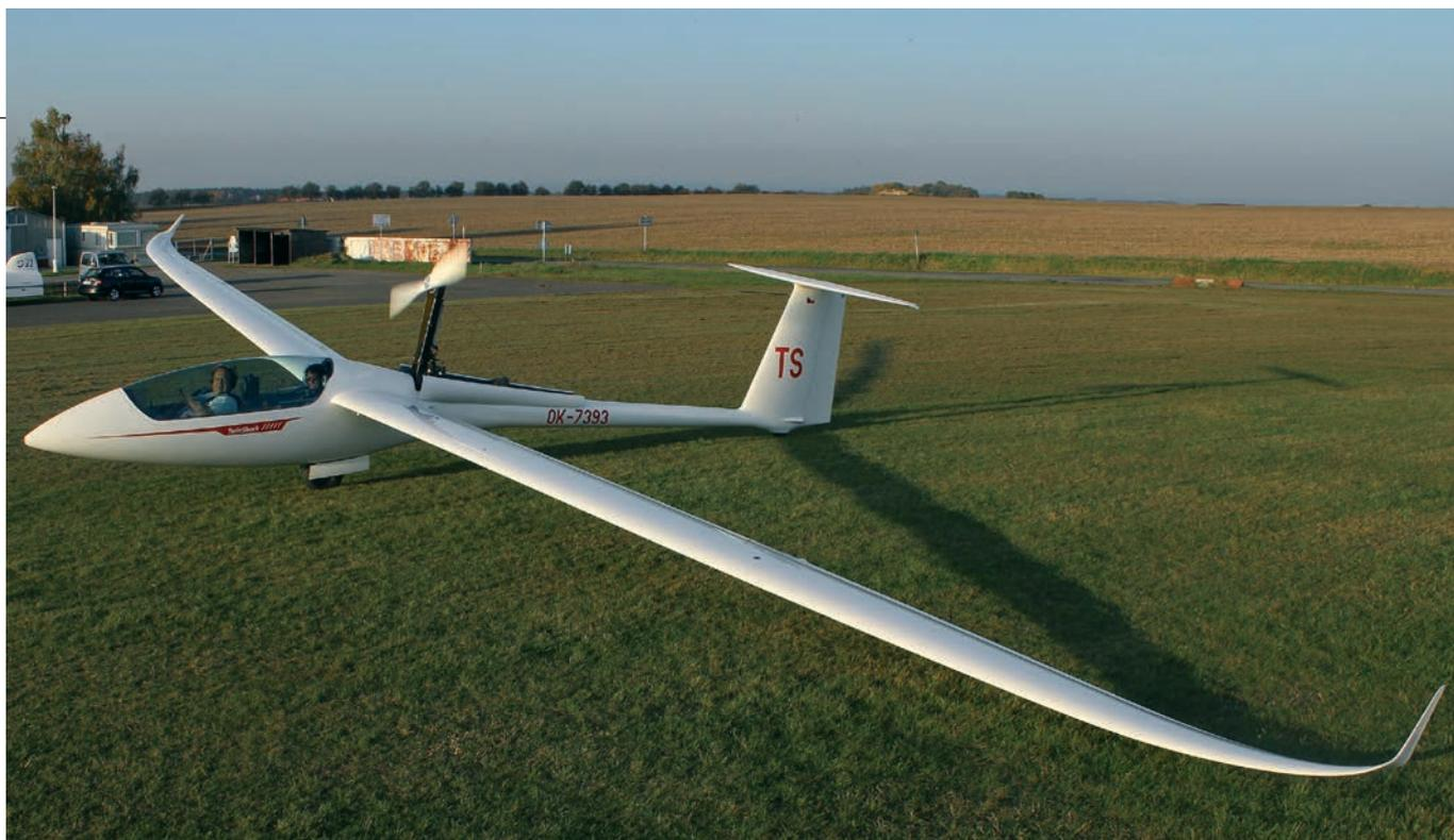
La potenza del motore (62 cavalli) consente una rapida accelerazione anche sull'erba. Gli alettoni sono efficaci sin dalle velocità molto basse
