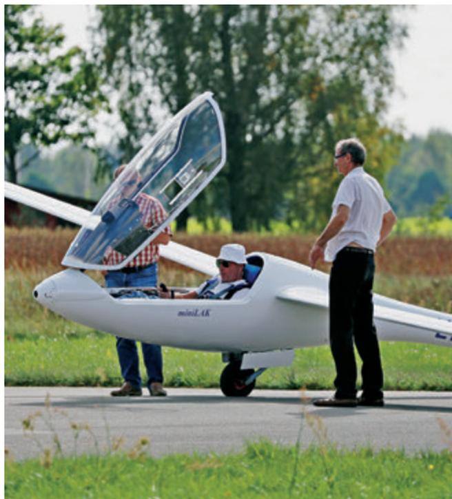
Il carrello ha le gambe allungate per allontanare l'elica dal terreno e permettere il decollo autonomo
