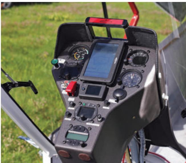
Sul pannello un Oudie, un logger, lo strumento del motore e, in basso, la radio
