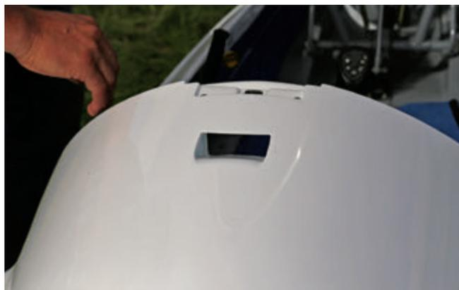
L'aliante è dotato di uno scarico in depressione dell'aria dell'abitacolo
