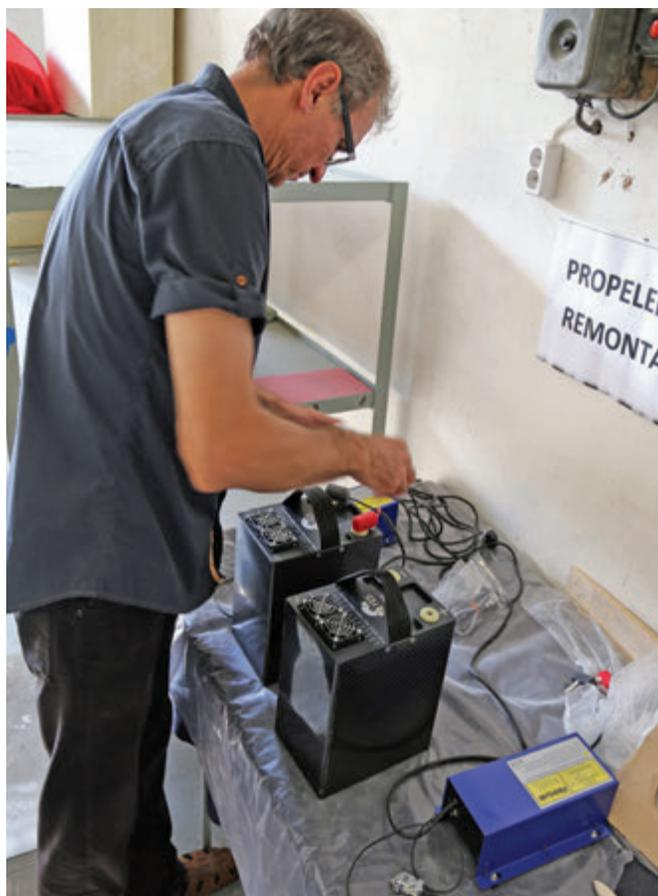
I due contenitori delle batterie al litio comprendenti l'elettronica di gestione
