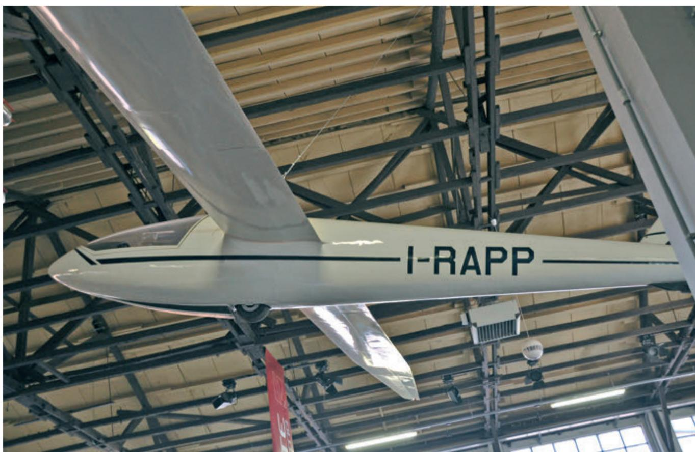
L'aliante A-3 è stato progettato agli inizi degli anni sessanta da Carlo Ferrarin e Livio Sonzio presso il Politecnico di Milano. L'A-3 è una derivazione dell'aliante A-2 ma con 18 metri d'apertura alare invece di 15
