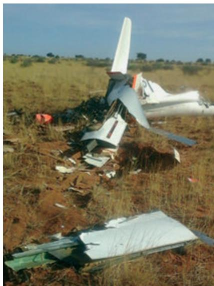
resi conto di non poter riconquistare il controllo del mezzo che era entrato in spirale picchiata. La perdita di controllo ha avuto inizio durante il volo in termica. L'abbandono dell'abitacolo è stato difficile, ed è finalmente riuscito a una quota inferiore a 700 metri sul terreno.
