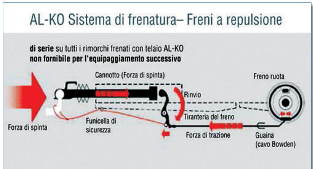
Il funzionamento del freno a repulsione
