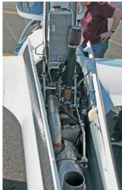
Il motore è fisso in fusoliera insieme allo scarico. Solo il pilone è mobile
