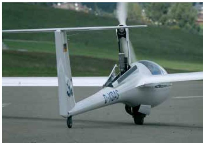
Il ruotino sterzante permette di muoversi sui raccordi e allinearsi facilmente
