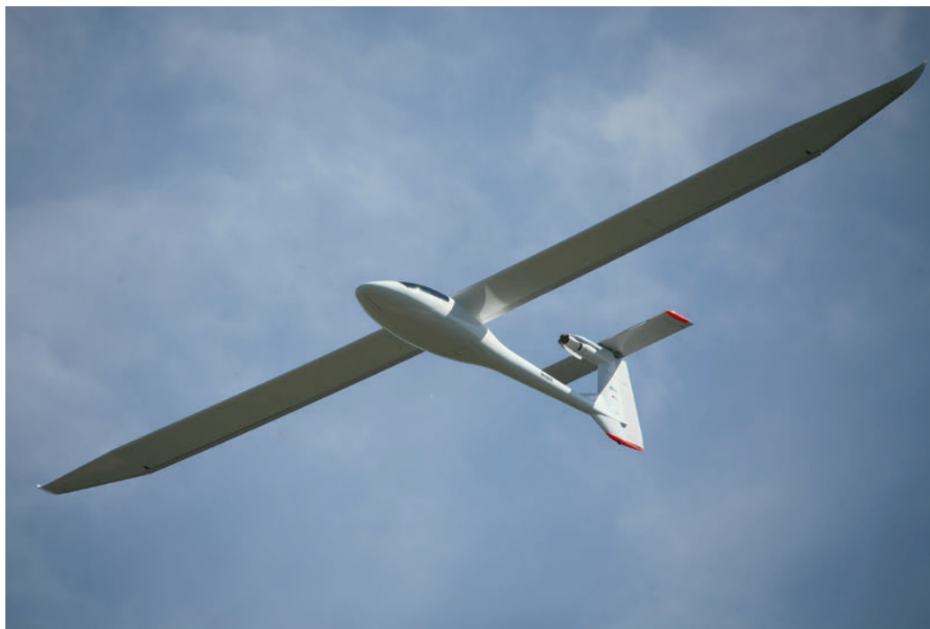
La fusoliera è stata creata negli stampi dello Stemme S10, cortesemente prestati dalla ditta tedesca
