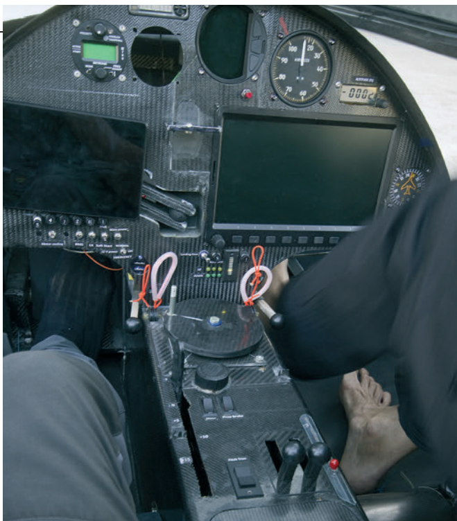
Ogni singolo comando è stato costruito da zero in compositi, nell'ottica del massimo risparmio di peso
