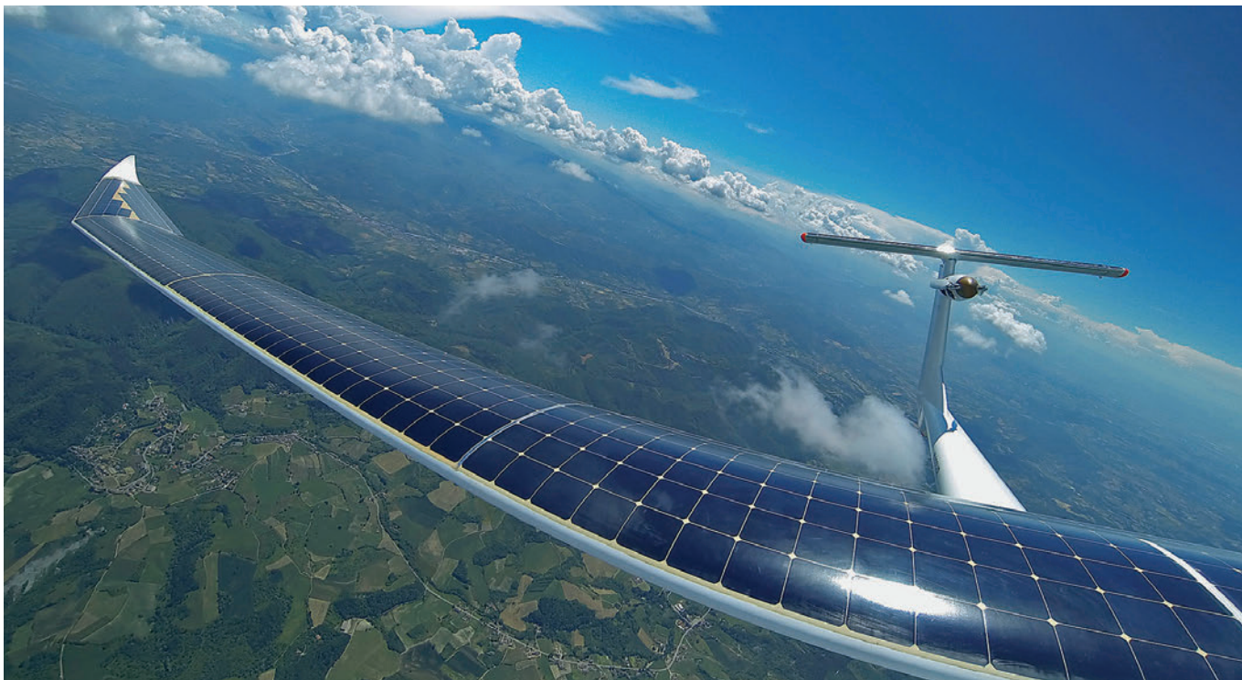
1.500 celle solari su ala e piano orizzontale generano fino a 5 kW di potenza, usata dal motore o stoccata nelle batterie
