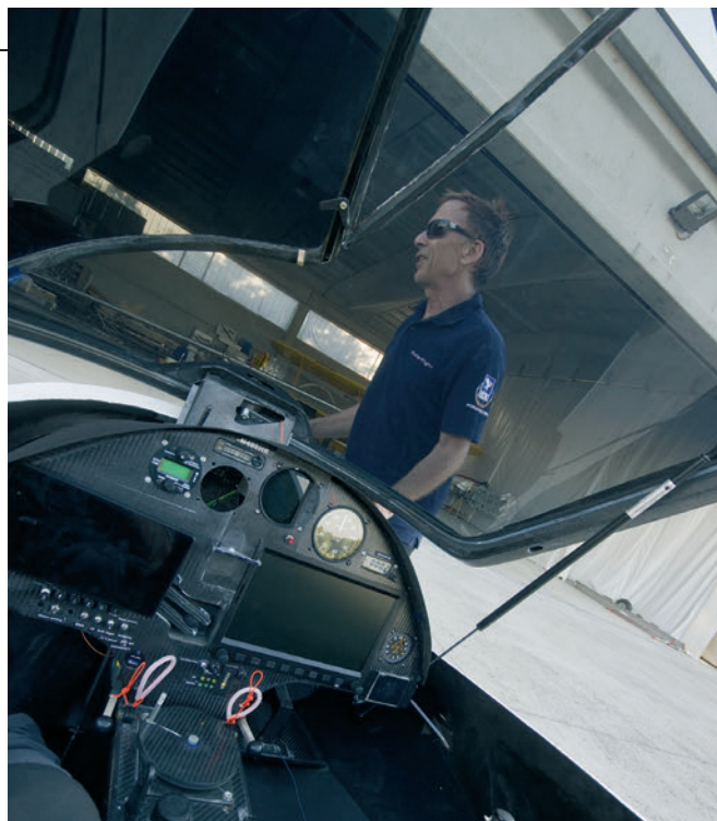
Abitacolo spazioso, confortevole e robusto. Il disco nero comanda la sterzata del ruotino anteriore
