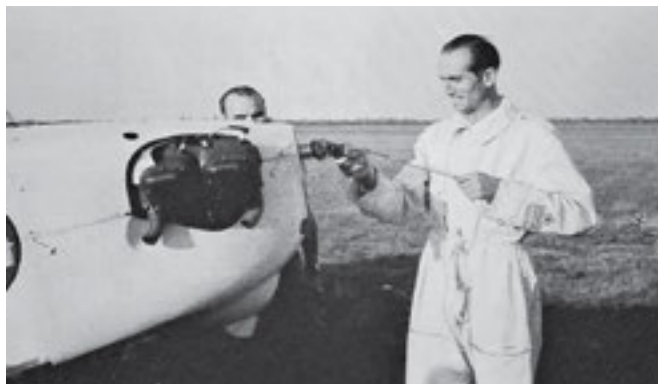
Ma è stato anche privato del castello motore per l'addestramento ai voli planati
