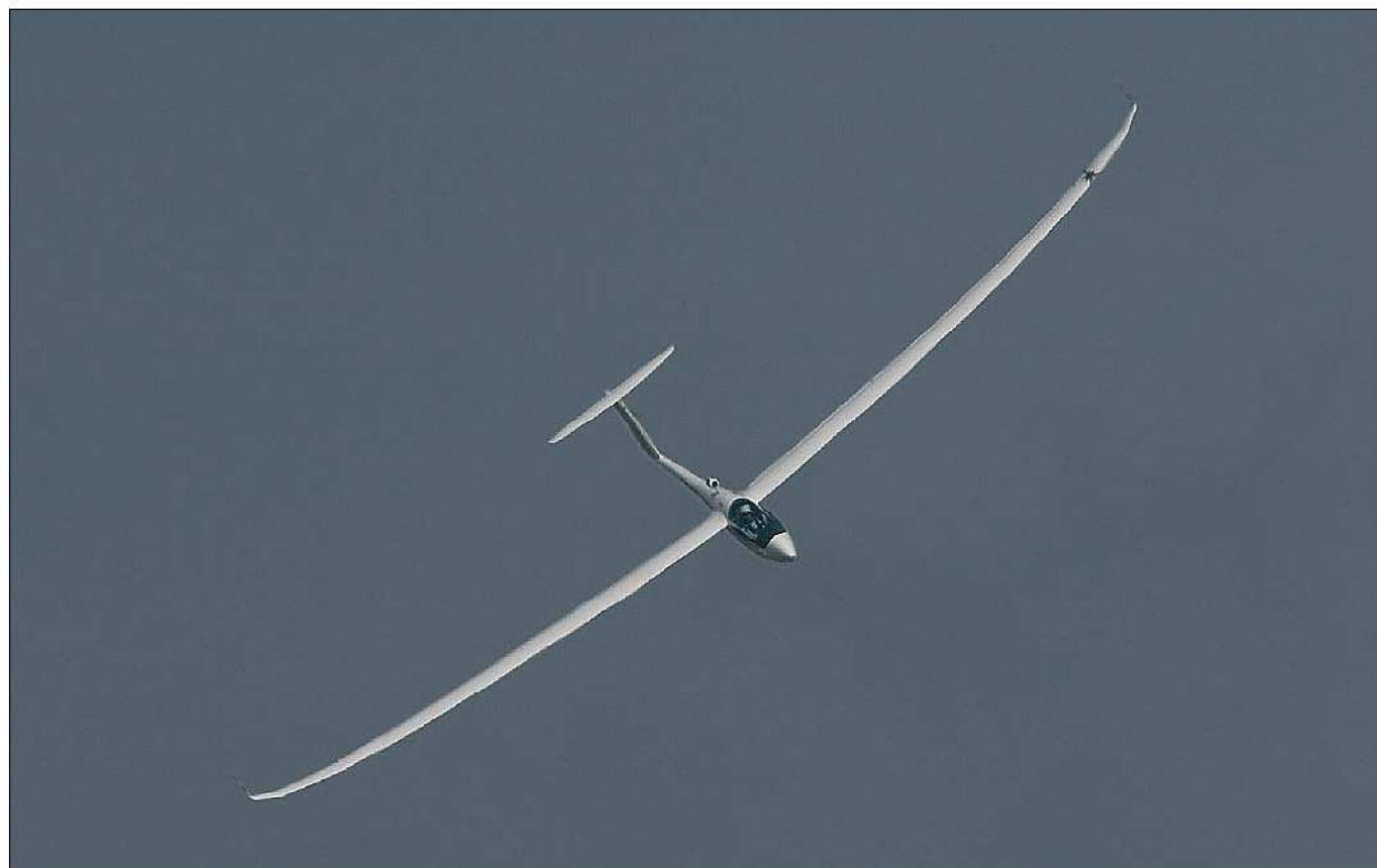
L'esibizione semiacrobatica del JS1 con motore a reazione. Spinge forte, sale circa 2 m/s anche a 160 km/h, ma la procedura di avviamento (ultra-semplificata) si prolunga per quasi due minuti
