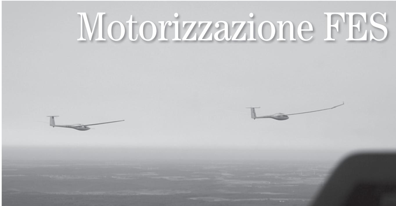
Misurazione delle prestazioni attraverso la comparazione con un aliante calibrato
