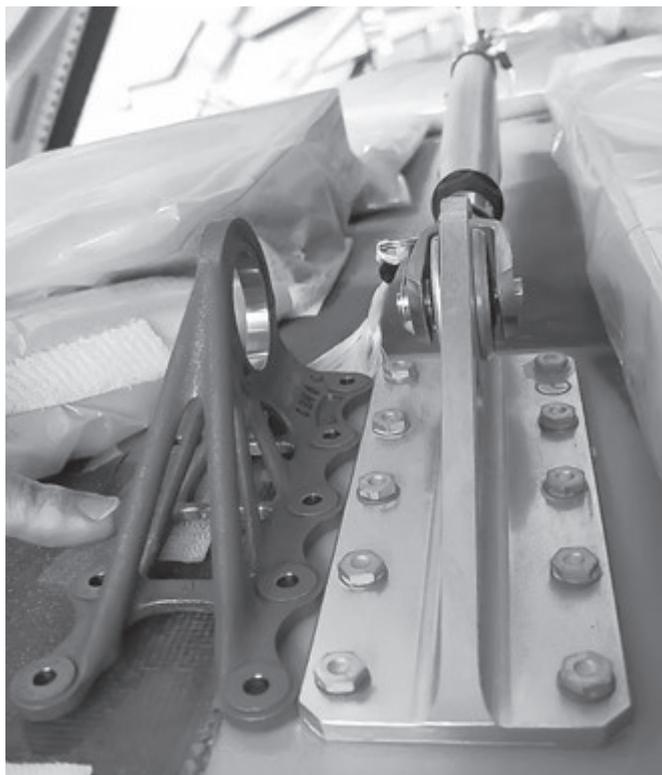
Il lavoro di finitura finale richiede l'asportazione di piccolissime quantità di materiale, con risparmio energetico e di materia prima, tempi di lavorazione ridotti, e un pezzo finito che pesa fino al 50% di quello in tecnica tradizionale. Il primo volo dell'Airbus dotato di questa nuovo particolare è avvenuto il mese scorso.
