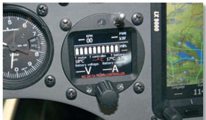
Lo strumento di controllo del motore
