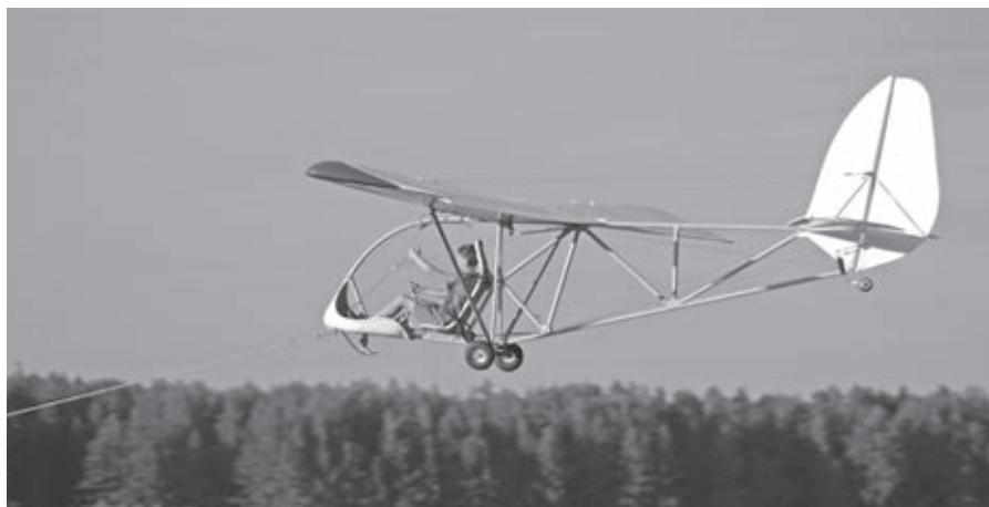
Un corto cavo verticale, vincolato a quello orizzontale di trazione, permette di sollevarsi da terra mantenendo la quota in limiti di sicurezza
