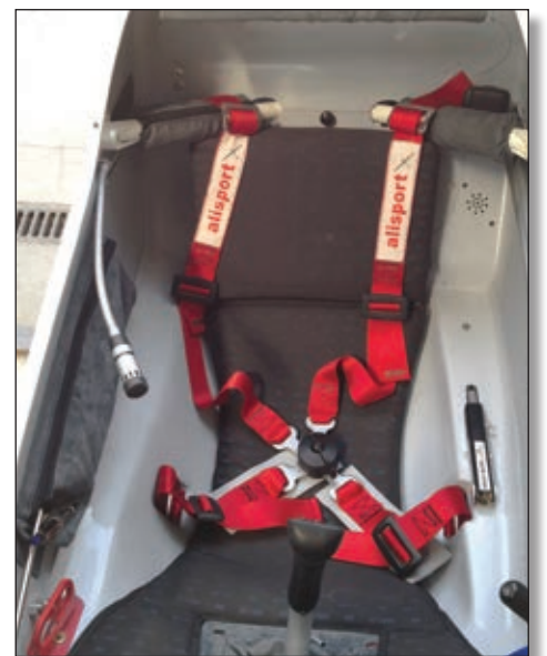
I due tubi metallici che collegano strutturalmente i perni di supporto delle semiali
