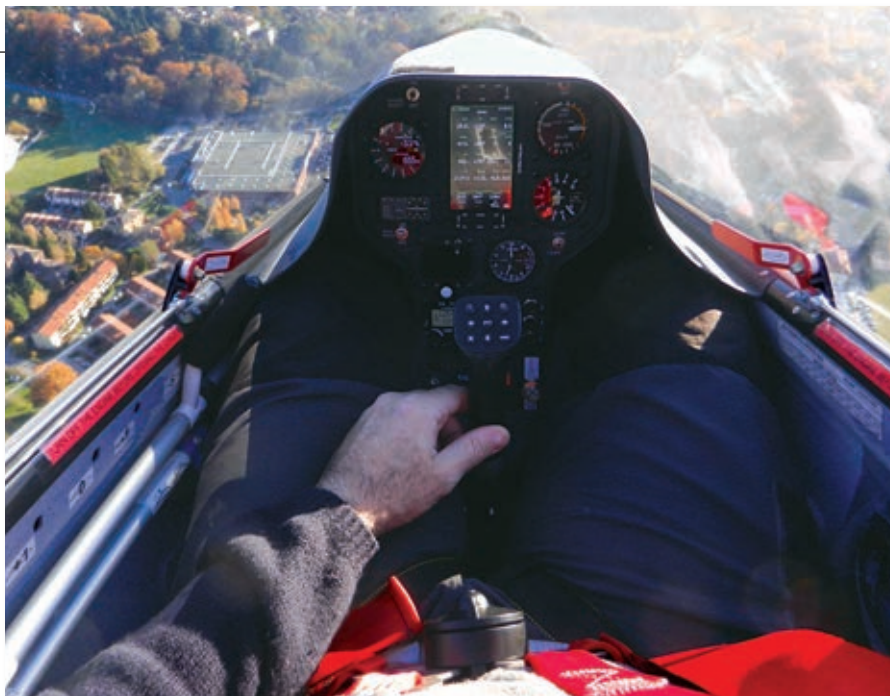
In prossimità della Vne. Comandi diretti e omogenei, con sforzi che aumentano insieme alla velocità
