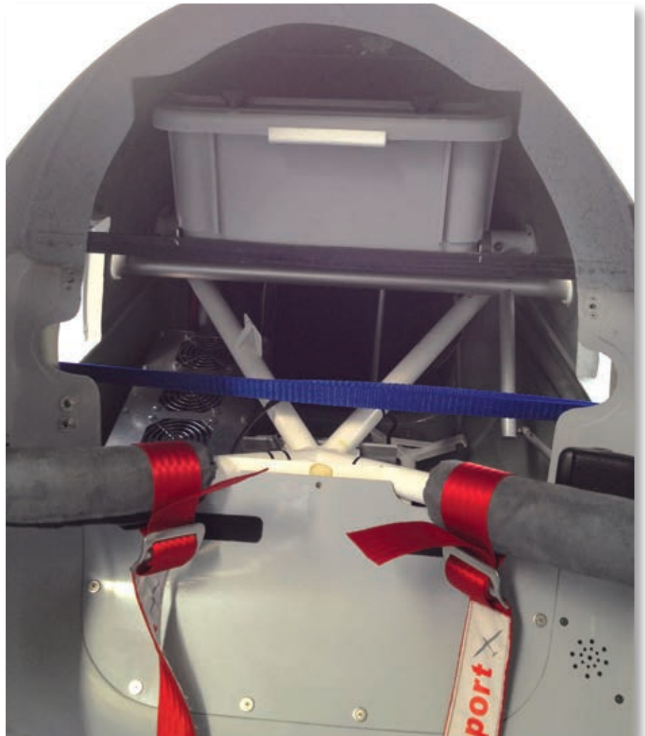
I due tubi metallici che collegano strutturalmente i perni di supporto delle semiali
