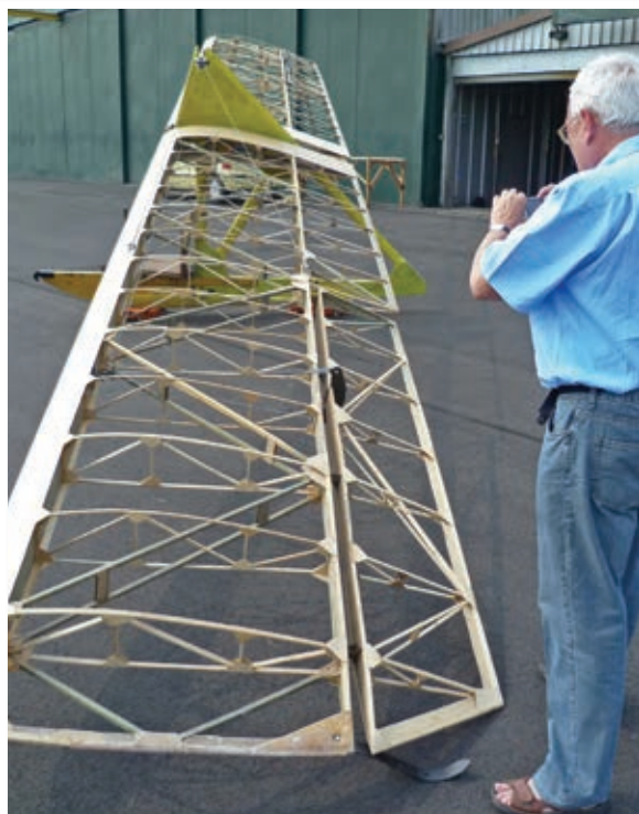
La struttura restaurata, senza la copertura
