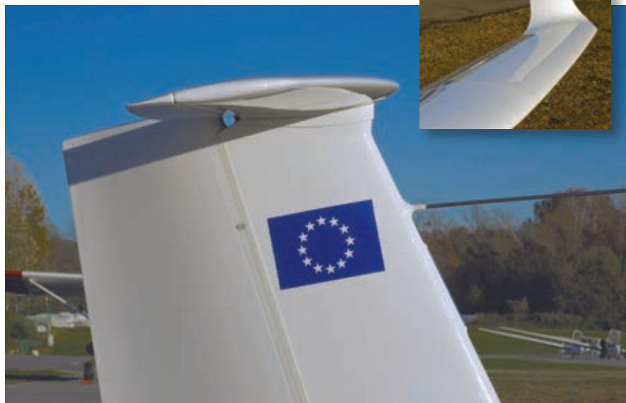
Il piano di coda a calettamento variabile, interconnesso con la leva di comando dei flap. La winglet ha preso una linea classica
