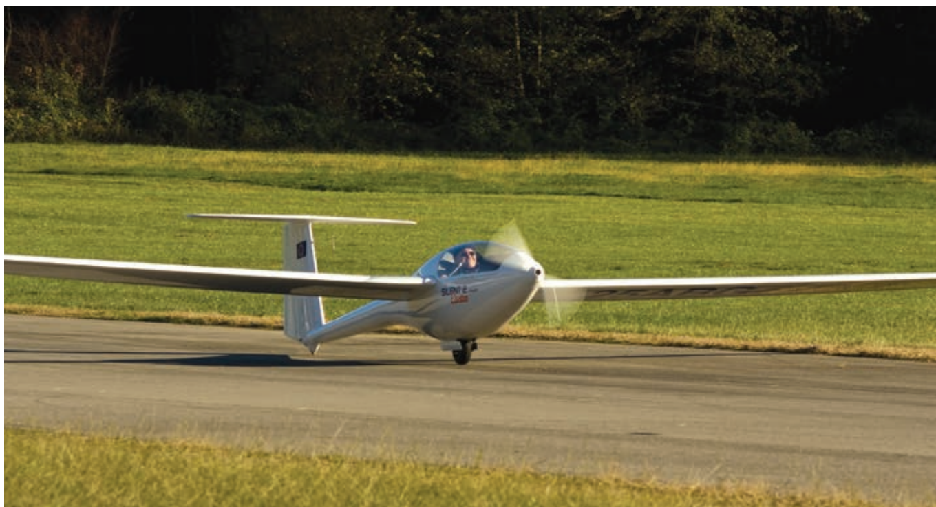
Il Silent decolla con la coda giù, garantendo buona luce al suolo per l'elica. Il cruscotto maggiorato in altezza però blocca la visuale anteriore
