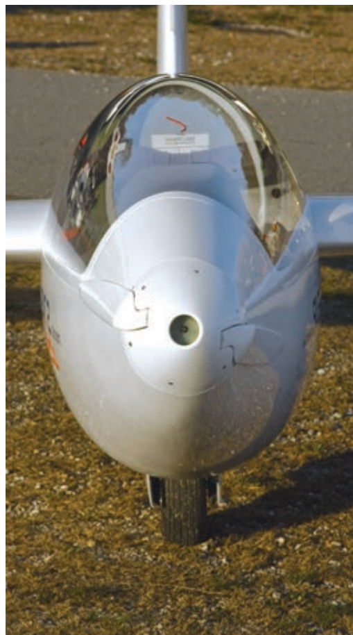
Il cono di prua è stato trasformato in ogiva dell'elica
