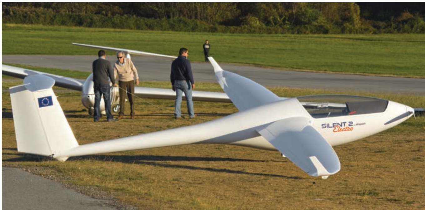
Il profilo del Silent con la magnifica ala ellittica. Si nota anche la cospicua parte di deriva dedicata al timone
