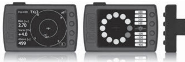
grare dati Flarm e dati ADS-b mostrandoli sul display a colori da 320 x 240 pxel, ben leggibile anche in pieno sole. Supporta il database Flarmnet e permette di registrare le ricezioni con un codice a scelta del pilota (di solito si usano le sigle di gara dei vari alianti), semplicemente con pochi click durante il volo. Il prezzo è di circa 240 Euro, Iva inclusa.
