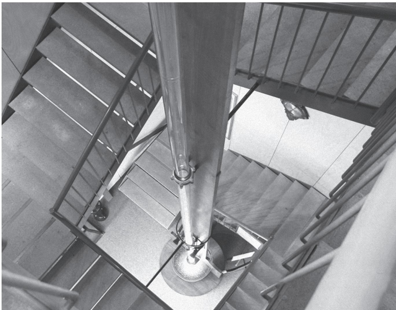
In Olanda è stato realizzato un barometro ad acqua, alto oltre 12 metri, sui disegni storici originali. In seguito è stato trasferito in Australia, ma ora giace smantellato per disaccordi con le autorità turistiche locali
