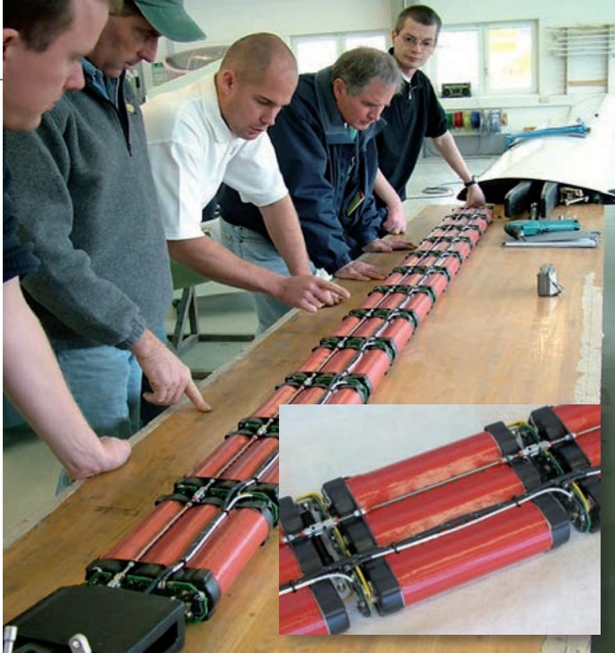
**Un gruppo di batterie al litio SAFT, estratto dalla semiala per un'ispezione. L'operazione è riservata ai tecnici abilitati, anche per il rischio di scariche elettriche e di danni ai circuiti**
