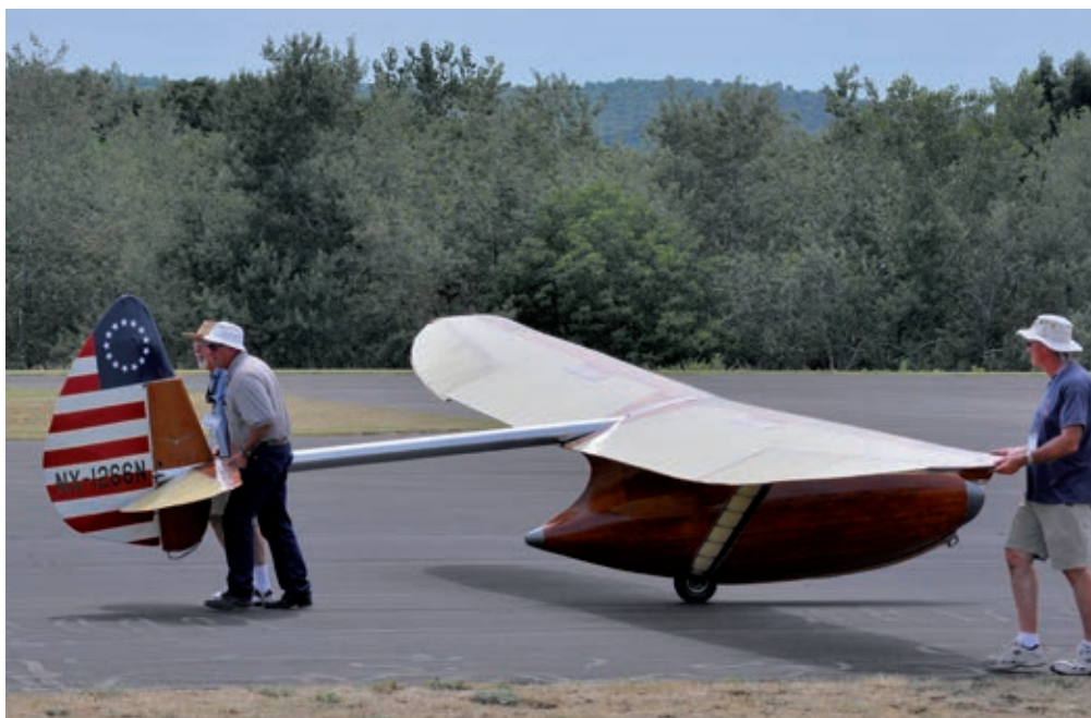
Il Bowlus Baby Albatross, diffuso in kit di costruzione, con trave di coda in tubo metallico. 13,5 m d'apertura, carico alare intorno a 17 kg/m 2
