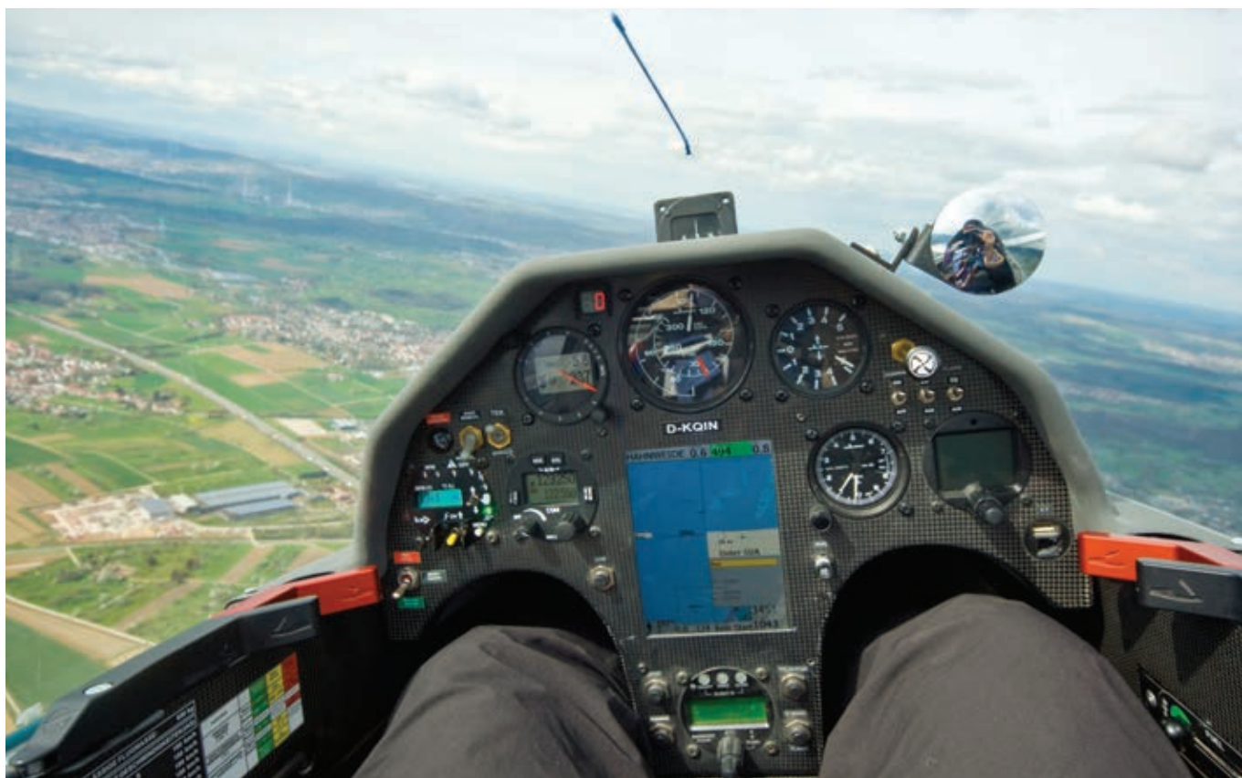
Un momento delle prove di stallo, ripetute per ogni settaggio di flap. La rimessa è immediata e le cadute asimmetriche sono rare
