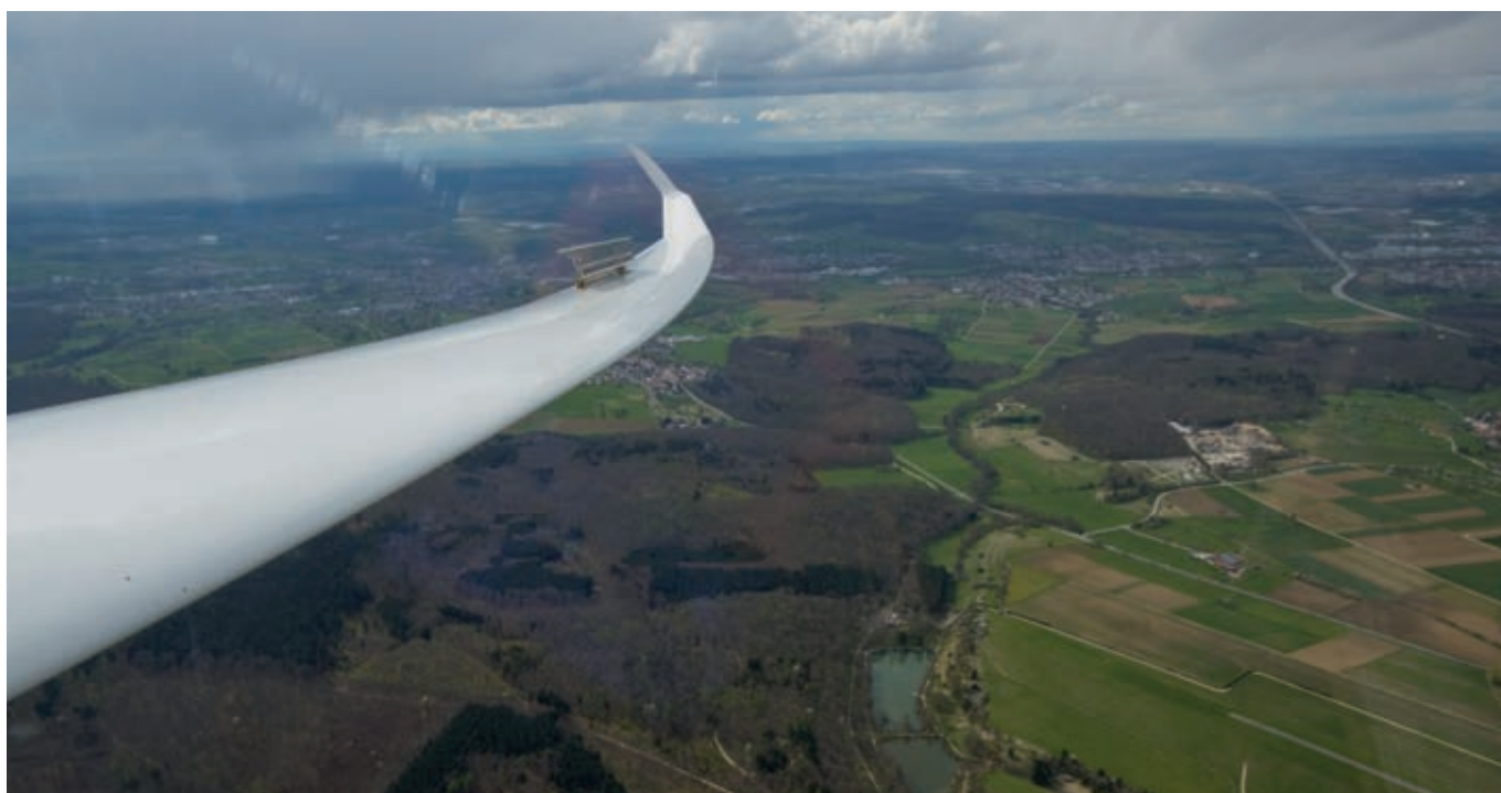
I diruttori sono installati in posizione inusualmente periferica, con vantaggio per gli sforzi strutturali in casi d'emergenza
