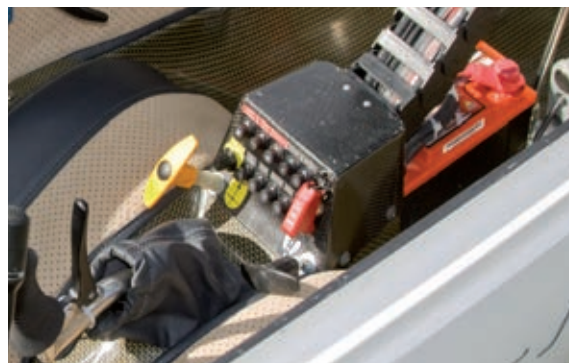
Il blocchetto con i numerosi braker dei circuiti elettrici; dietro di esso, la batteria principale
