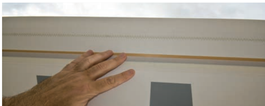
La striscia di turbolatori installata nel ventre dei flaperoni testimonia l'estesissima laminarità dell'infradosso (fino al 95 %)
