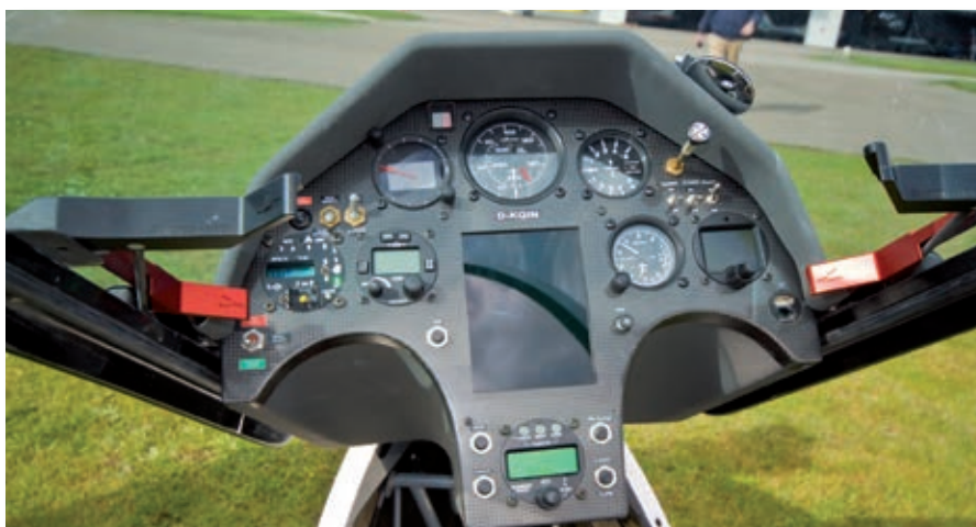
Schermo grafico e vario-computer della Clear-Nav. Nuove e ben disegnate le leve di sblocco della capottina
