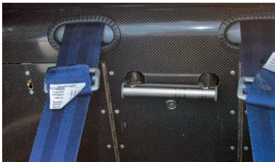
Schienale: La barra metallica dietro lo schienale, caricata da una molla pneumatica, sostiene il pilota e consente la regolazione anche in volo.
