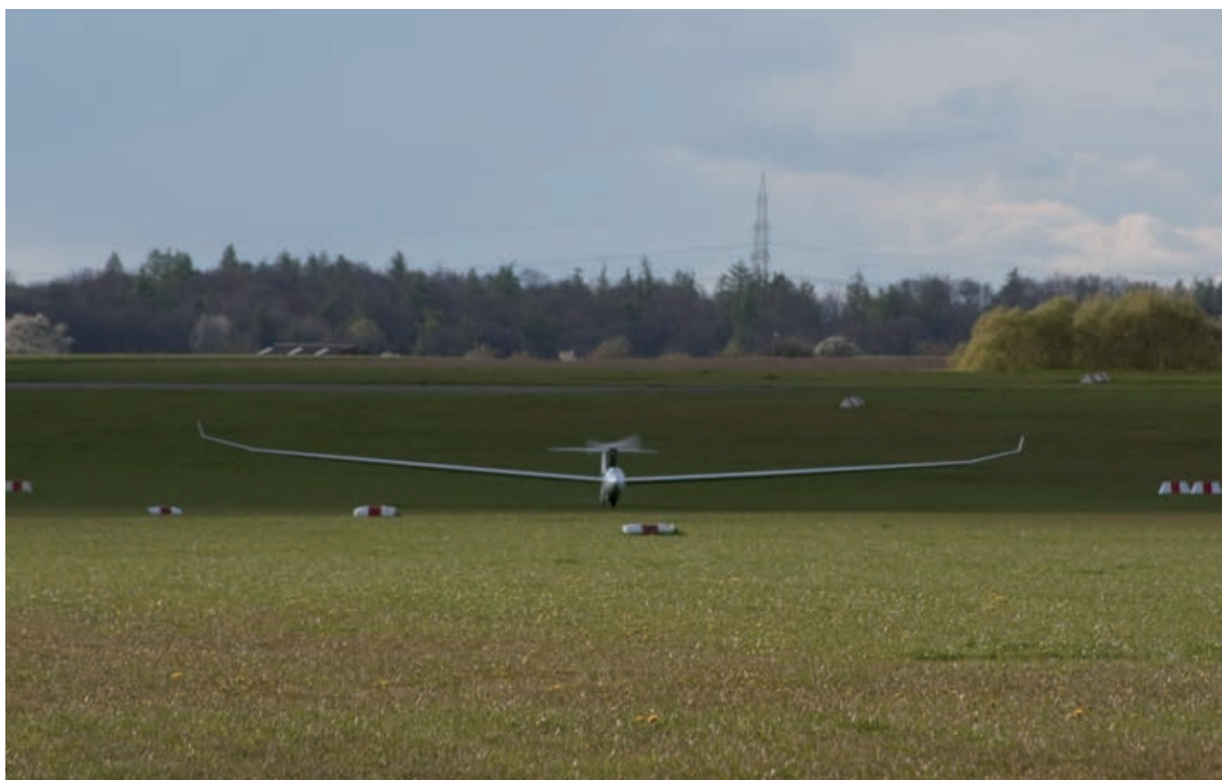
L'inizio della corsa di decollo. Dopo i primi metri d'accelerazione, si può dare gas senza rischiare di puntare il muso nel terreno
