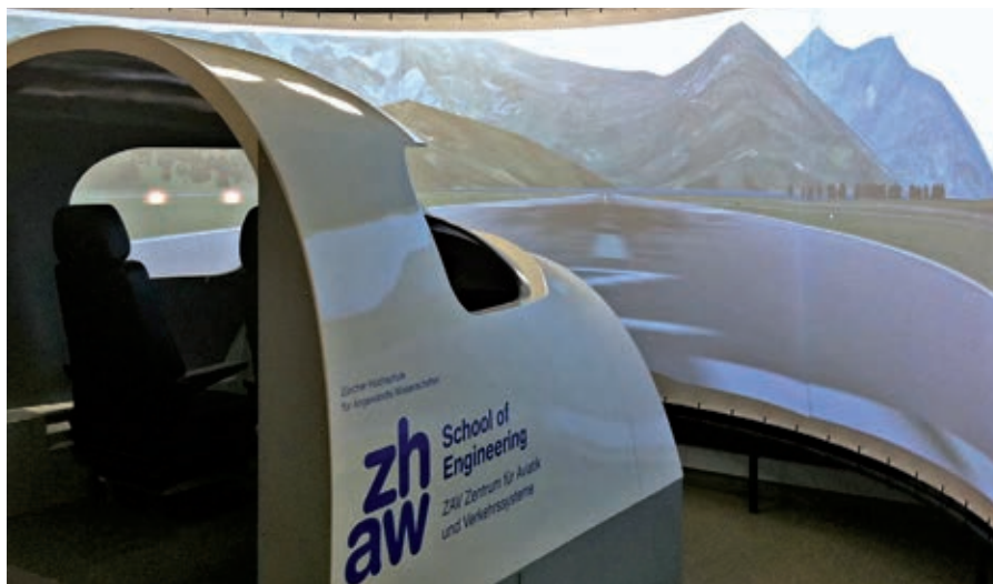
Immagine del cockpit (simile a quello del PC-12, ingrandito per facilitare l'accesso) e dello schermo a 180 gradi. Pista di Buochs.
