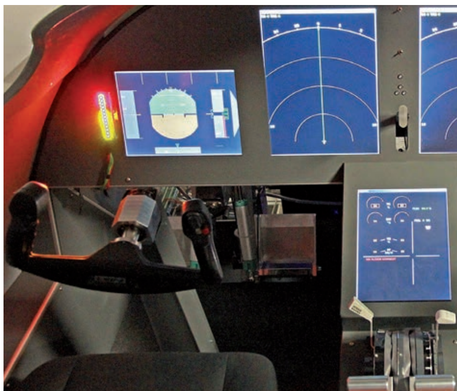
5 schermi LCD completamente riconfigurabili. È mostrato il layout básico: indicatore d'assetto a Led, velocità, salita, prua, parametri motore di base (in questo caso per un biturbina). Presenti alcuni interruttori, leva del carrello, manette motori, leva aerofreni, flap. Lo sviluppo di nuovi pannelli strumenti molto più avanzati è in corso.
