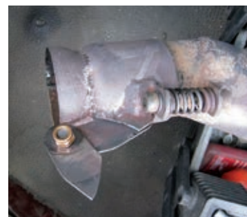
Fig. 10 - 1 Rottura di una delle alette del supporto della marmitta
