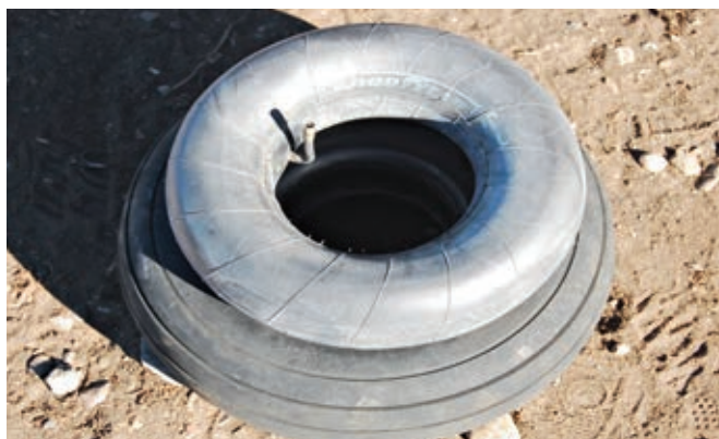
Fig. 12 - Camera d'aria da 5 pollici in una gomma da 6 pollici: installazione certificata EASA, ma sbagliata
