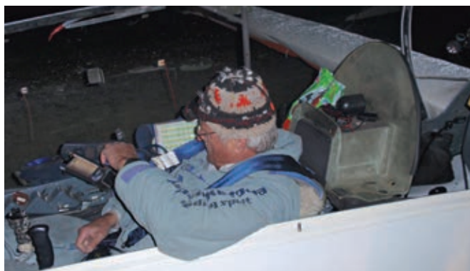
Fig. 13 - In configurazione per volo solista: una paratia in fibra autocostituita isola l'abitacolo anteriore impedendo la caduta di oggetti nel posteriore, dove non sarebbero recuperabili. Piove ma sono pronto a partire
