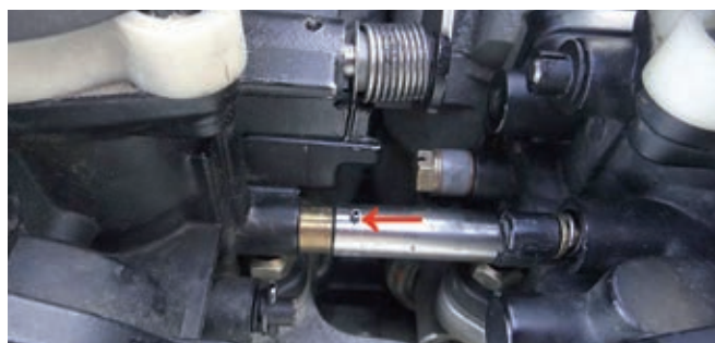
Fig. 9 - Spina elastica Ø2mm difettosa
