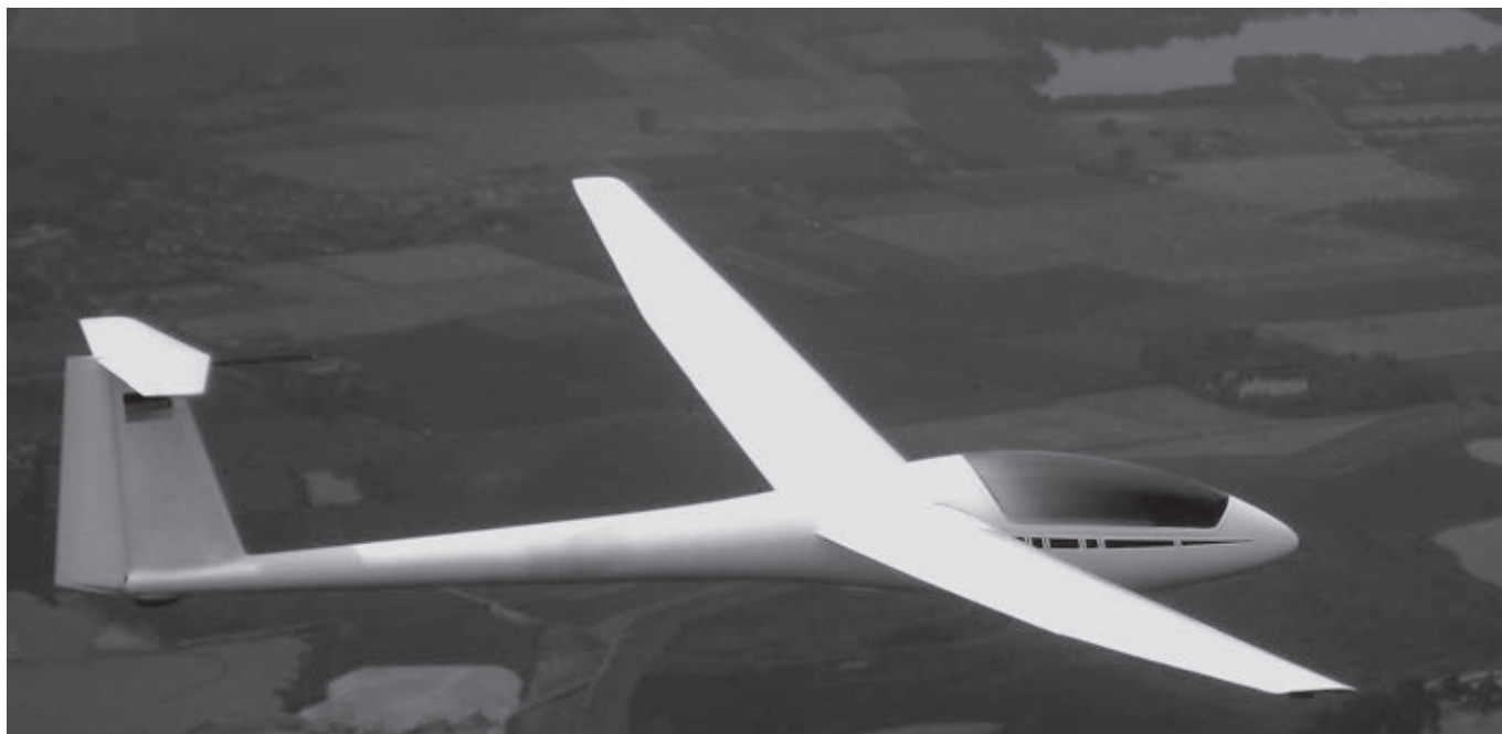
Appare ancora moderna la linea dell'LS1 (nato nel 1968), soprattutto in questa variante "f" con capottina integrale e piano di coda fisso
