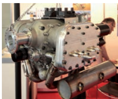
Leggerissimo il D-Motor: 47 kg
