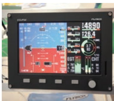
FlyBox Eclipse, strumento italiano per ULM
