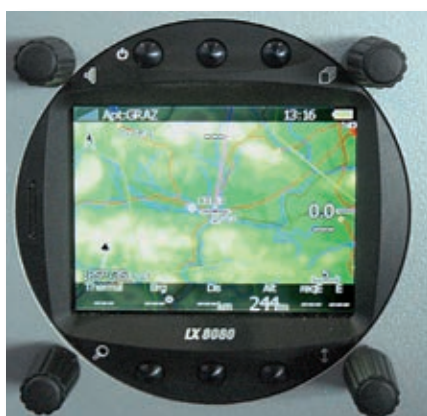
LX-8080: display a colori in formato standard 80 mm
