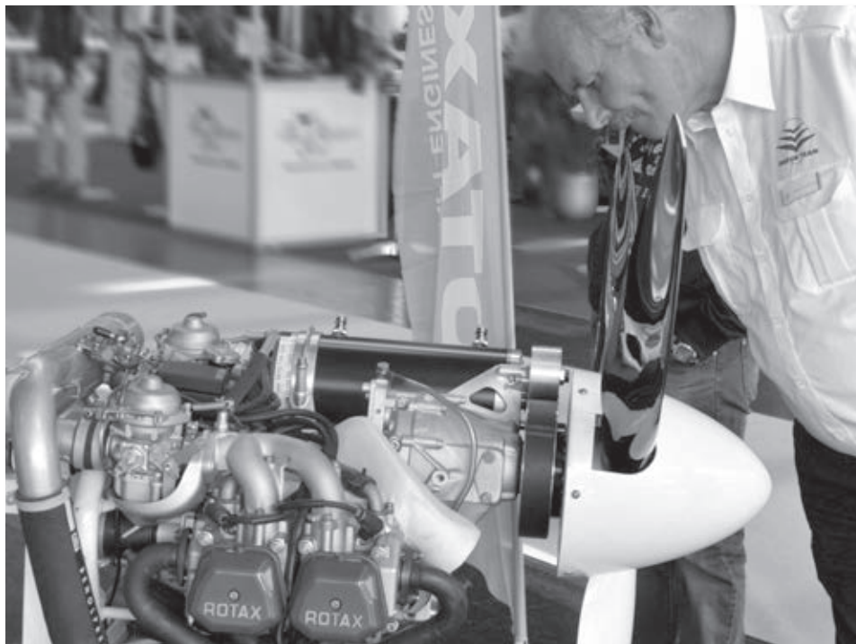
Il motore Rotax 912 con sistema ibrido (propulsione anche elettrica)
