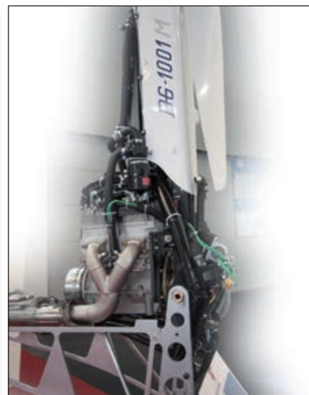
... e il motore per il decollo autonomo del DG-1001 con trasmissione a 5 cinghie parallele
