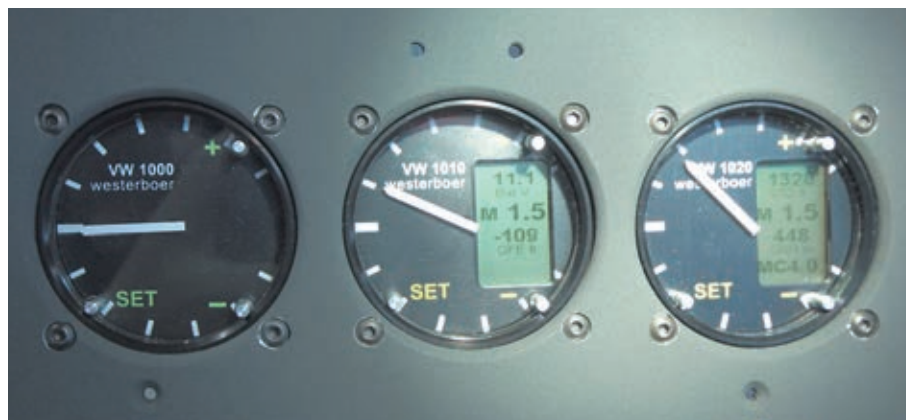
La nuova serie di variometri Westerboer, con unità di sensori da installare nella deriva
