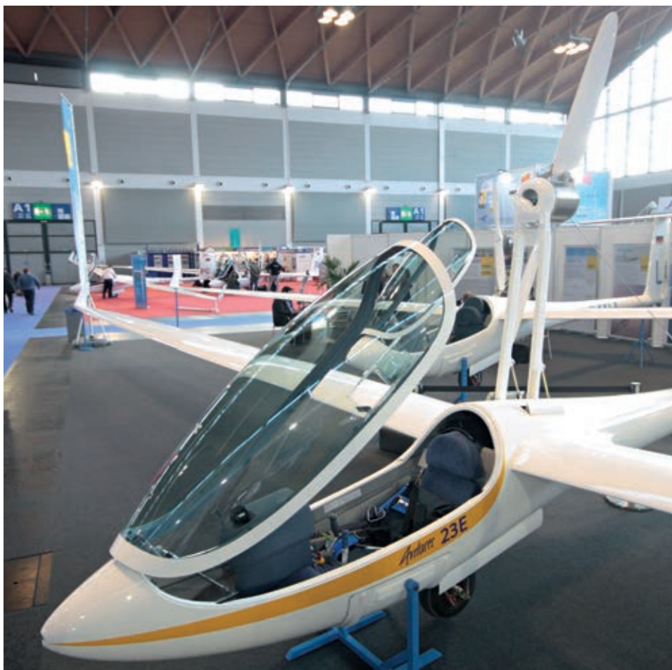
L'Antares 23 metri, con motore elettrico, nuovo classe libera della Lange, che presta le ali anche al Quintus
