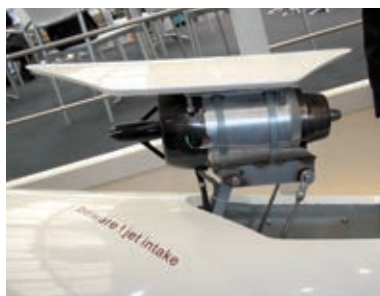
La turbina realizzata per gli alianti dalla M&D, con 40 kg di spinta
