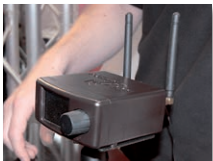
Funzioni integrate di anticollisione: Flarm e ADS-b nell'apparato denominato Power Flarm
