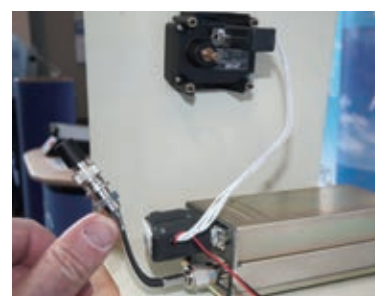
Vista del transponder TRIG con l'unità di controllo separata
