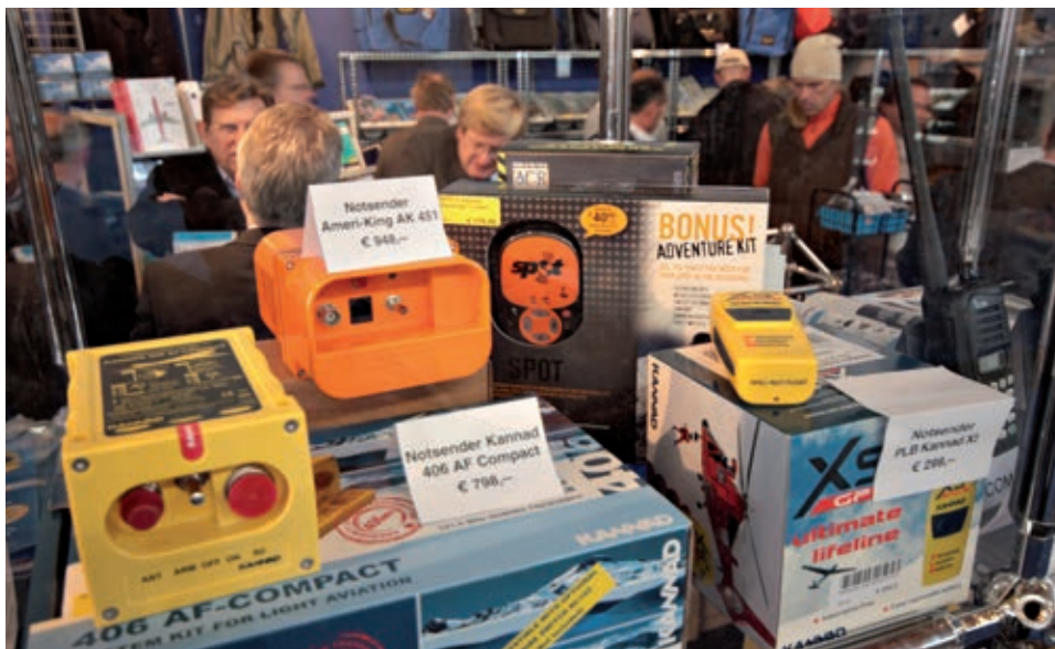
Apparati ELT e PLB per localizzazione d'emergenza
