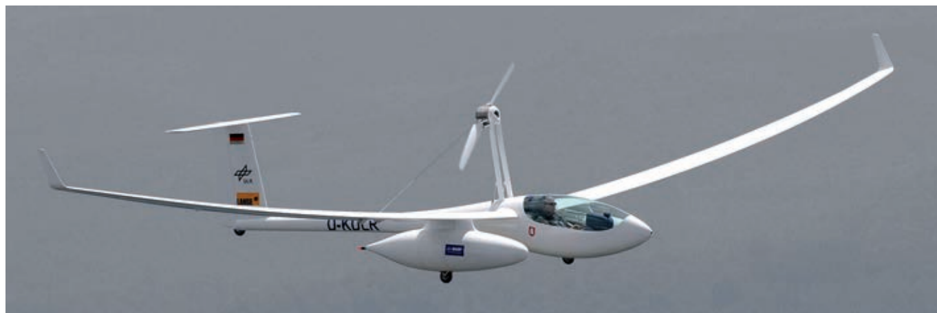
L'Antares H2, con propulsione elettrica alimentata da celle a combustibile (idrogeno), è un esemplare sperimentale come il fratello maggiore H3
