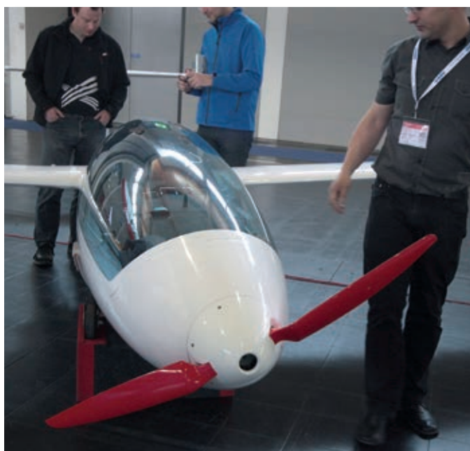
L'elica e il vano batterie del motore di sostentamento FES, installabile sui LAK e altri alianti con cono di prua non troppo minuscolo
