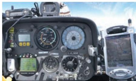
**Strumenti a fondo scala: manteniamo la Vne a 5.000 m con 5,4 m/s di metto e 322 km/h di Ground Speed**
