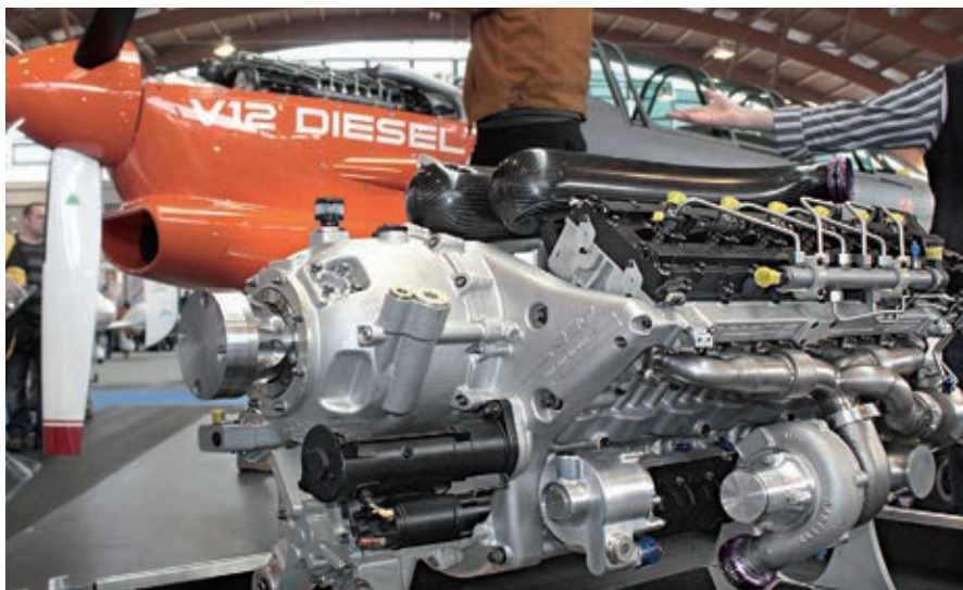
Un motore di forte impatto visivo: diesel, 12 cilindri a V
