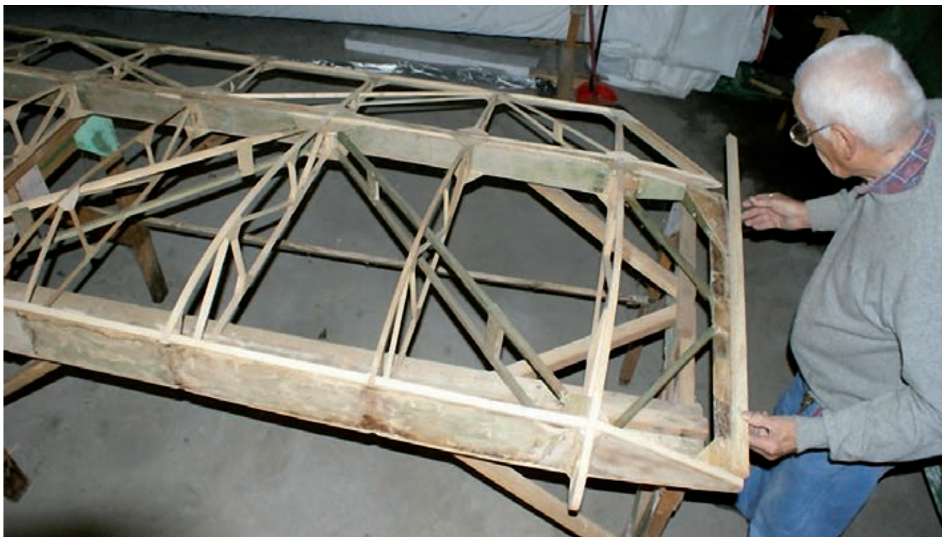
Un'altra immagine della struttura dell'ala. Alla base dello scalo è visibile il longherone dell'ala destra, unico elemento che è stato possibile recuperare
