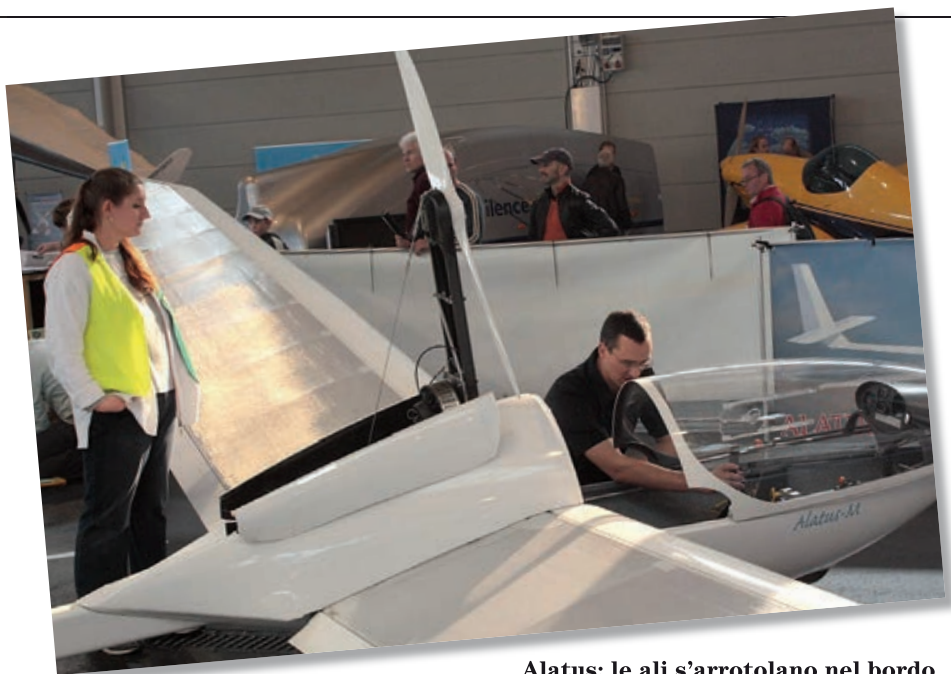
Alatus: le ali s'arrotolano nel bordo d'attacco, e l'aliante trova posto sul tetto di un'auto
