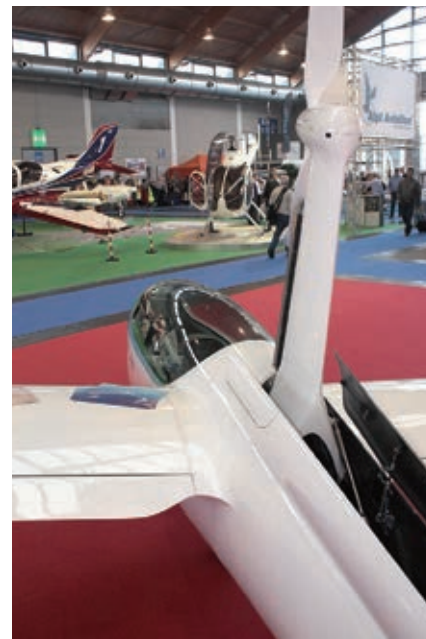
La trasmissione cardanica nascosta nel pilone rastremato
