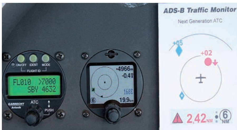
Un display grafico mostra il traffico circostante grazie al transponder e al ricevitore ADS-b
