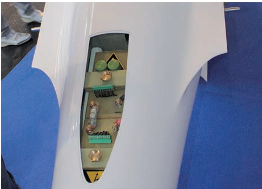
Il vano batterie da 20 kg realizzato in fusoliera
