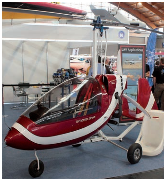
Il Gyrotec, compattissimo. Il pilota siede nel serbatoio carburante anatomico
