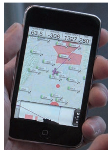
Un display grafico mostra il traffico circostante grazie al transponder e al ricevitore ADS-b
