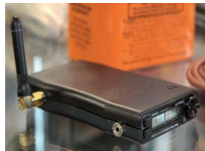
Il piccolo ricevitore Zaon MRX emette un allarme acustico e visivo in prossimità di aeromobili dotati di transponder
