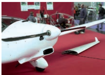
L'elica in bandiera per il volo a motore spento
