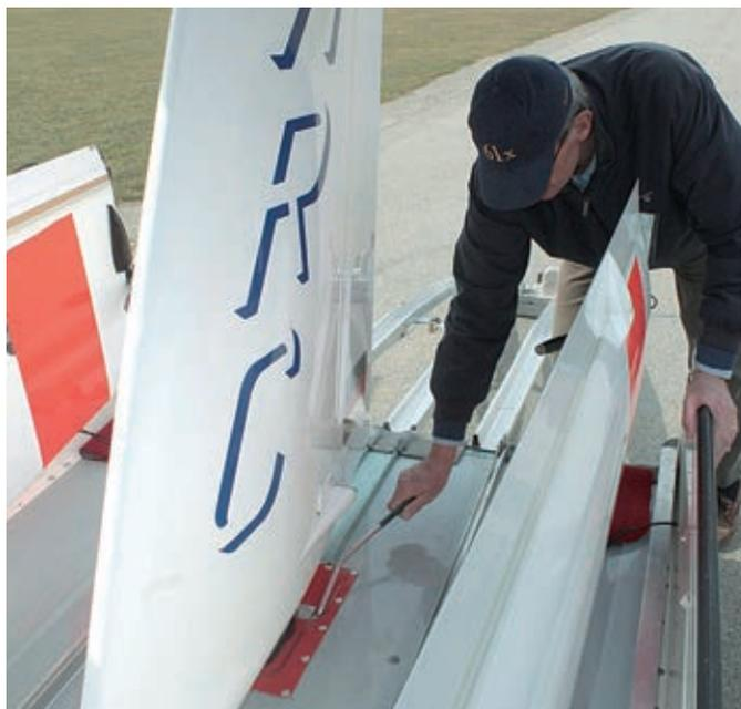
Comoda la nuova opzione Cobra: una leva per sollevare la coda e facilitare l'uscita della fusoliera
