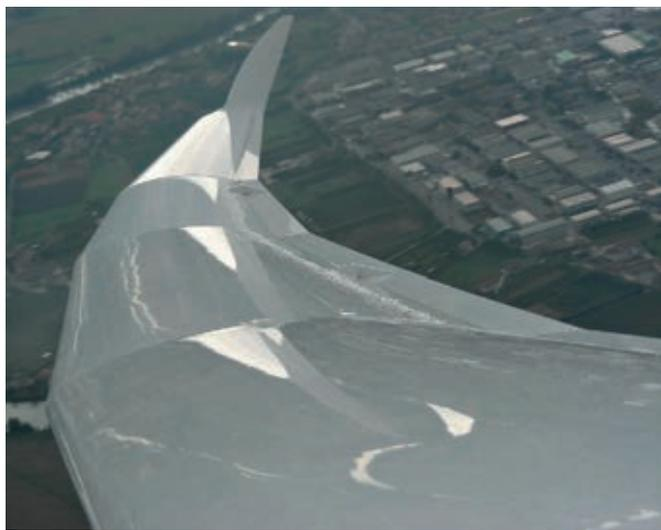
Ciò testimonia che la laminarità dei profili adottati è straordinariamente estesa, e che l' indesiderabile bolla di separazione si genera in posizione arretrata, dove è minore il danno aerodinamico. La sensibilità del profilo alla presenza delle gocce d'acqua appare modesta, a garanzia di prestazioni decenti anche ad ala bagnata. La pioggia, sempre deleteria per il volo plana-
