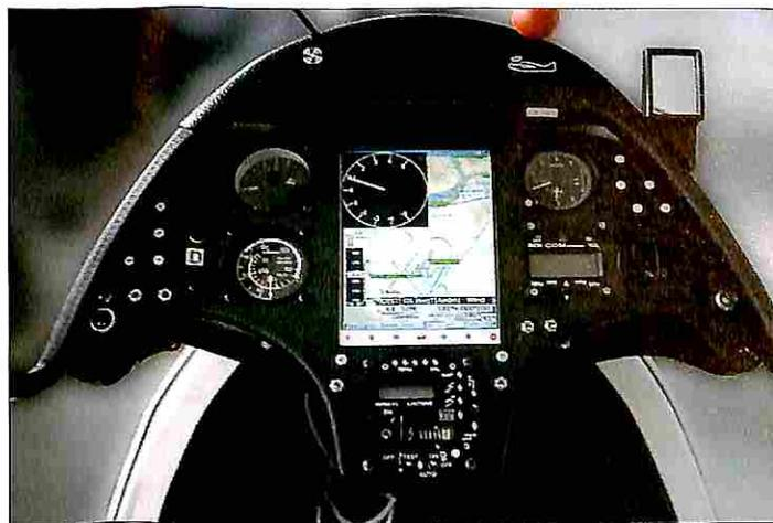
**Un esempio reale di installazione sul cruscotto di un ASH-25, ripreso in condizioni medie di luce solare**
