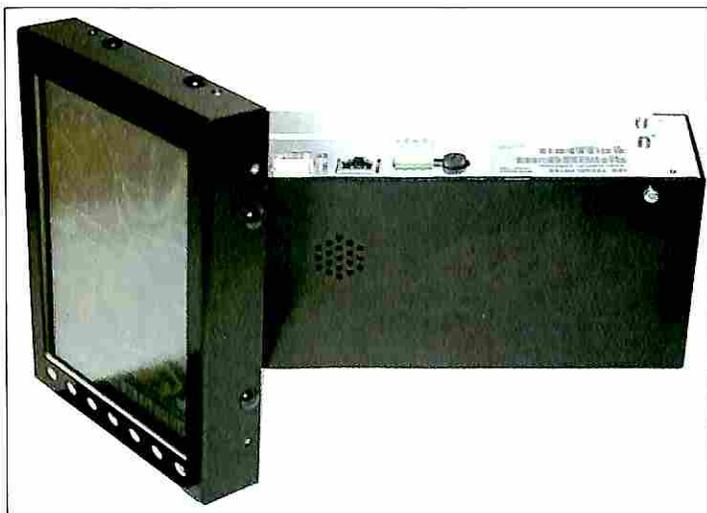
**Il display touch-screen e, in secondo piano, il box con il processore**
