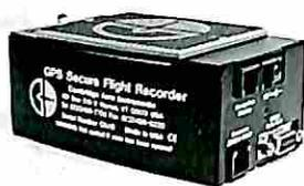
La sostituzione della batteria può essere effettuata in proprio, con pochissima spesa, senza inviare il registratore ad un laboratorio autorizzato. Serve solo una batteria del tipo 2325, reperibile nei negozi di materiale elettronico. Ecco il semplice procedimento:
