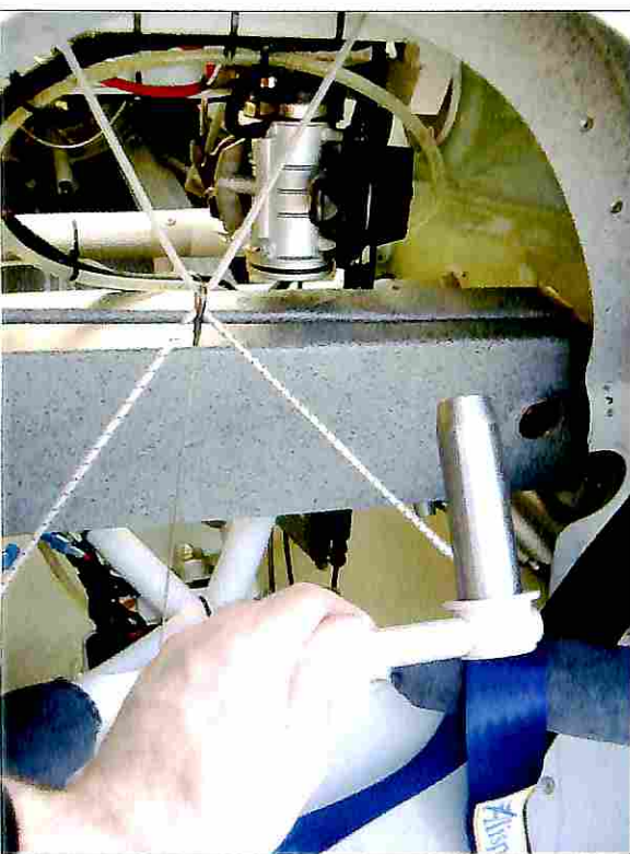
Uno dei perni principali che assicurano le due semiali; il bloccaggio di sicurezza è garantito da un bullone coassiale. Più indietro, si vede il corpo farfallato (presa d'aria del motore)
