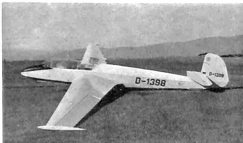
Il Kranich III D 1398 - Questo aliante è carico di strumenti. Fra l'altro, al secondo posto di pilotaggio, lo SFIM A-20 il nuovo apparecchio registratore francese per la misurazione contemporanea dei seguenti valori: quota-velocità dell'aliante - temperatura - accelerazioni.
