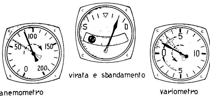
Fig. 11 - Comportamento degli strumenti nel caso di caduta in vite destra per perdita di velocità.
