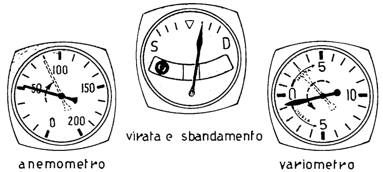
Fig. 12 - Posizione degli strumenti durante una forte scivolata d'ala in virata destra.
